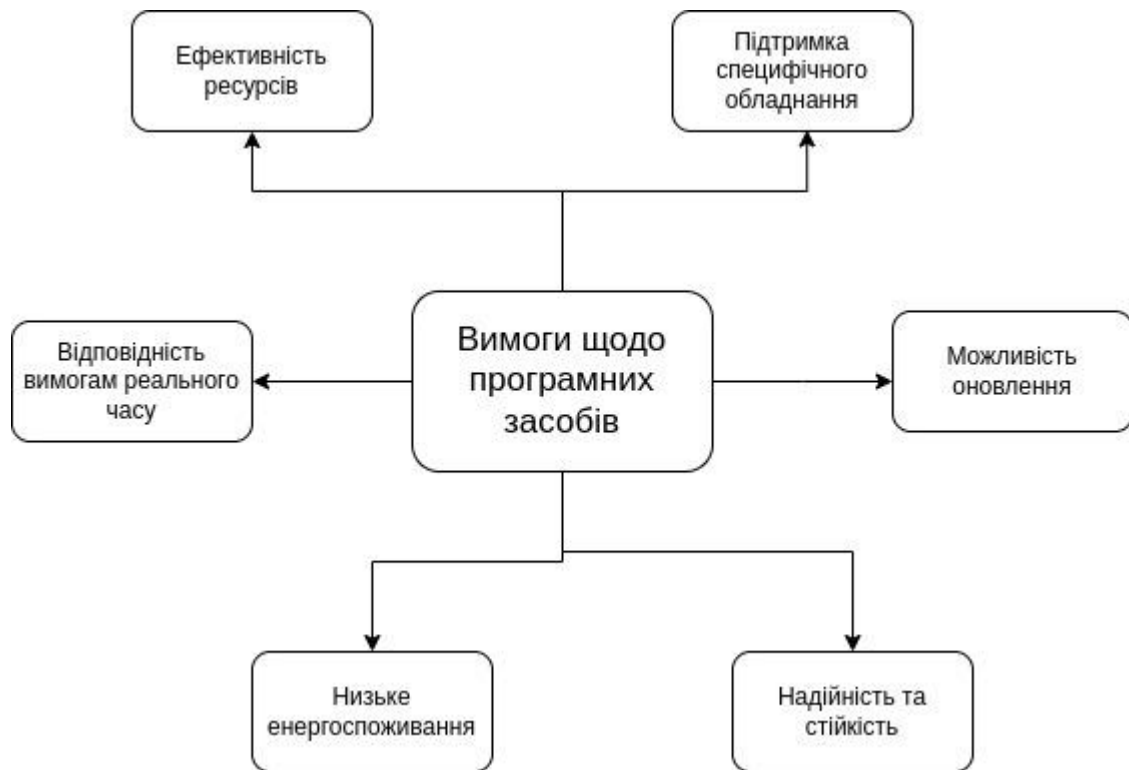
Рисунок 3.1 - Вимоги щодо програмних засобів підтримки вбудованих процесорних систем
