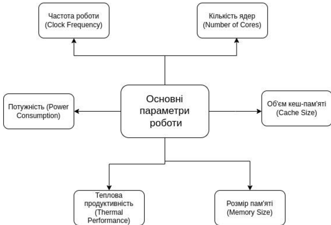
Рисунок 3.2 - Основні параметри роботи вбудованих процесорних систем
