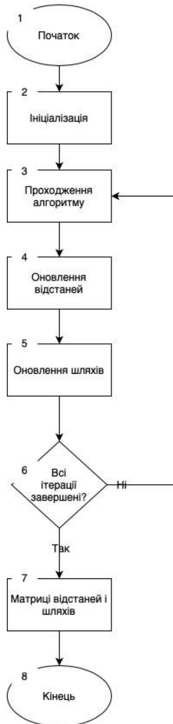
Рисунок 1.5 – Блок-схема алгоритму Флойда-Уоршалла
