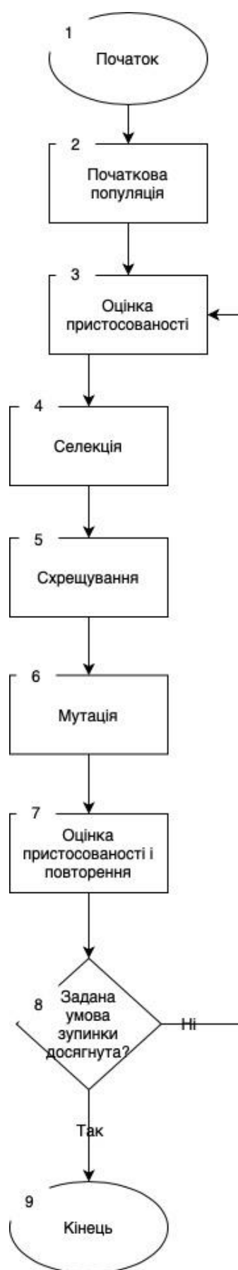
Рисунок 1.4 – Блок-схема генетичних алгоритмів
