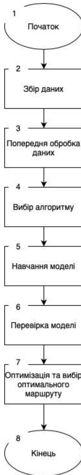
Рисунок 1.6 – Блок-схема основного алгоритму пошуку маршруту на основі штучного інтелекту
