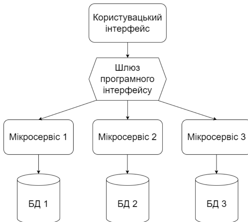
Рисунок 2.1 -Принципова схема додатку з мікросервісною архітектурою
