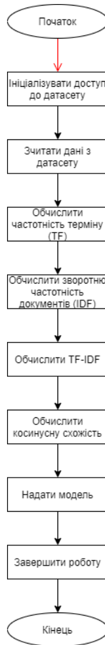
Рисунок 2.4 – Блок-схема алгоритму роботи методу навчання моделі
