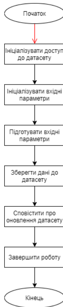
Рисунок 2.3 – Блок-схема алгоритму роботи модуля оновлення датасету
