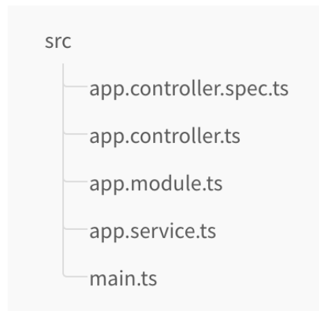
Рисунок 3.1 - Базова файлова структура серверу в Nest.js
