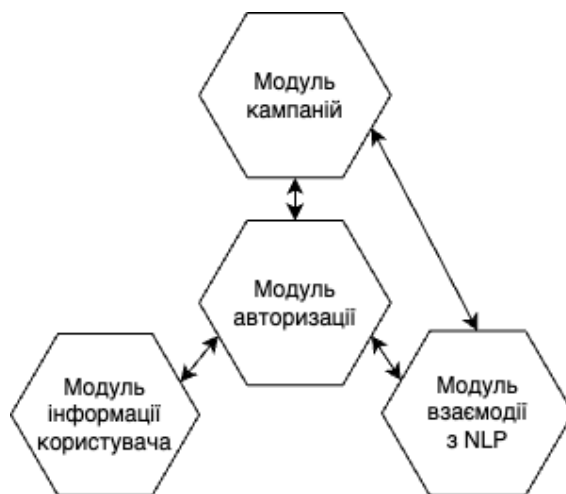
Рисунок 2.9 – Архітектура модулів серверної частини
