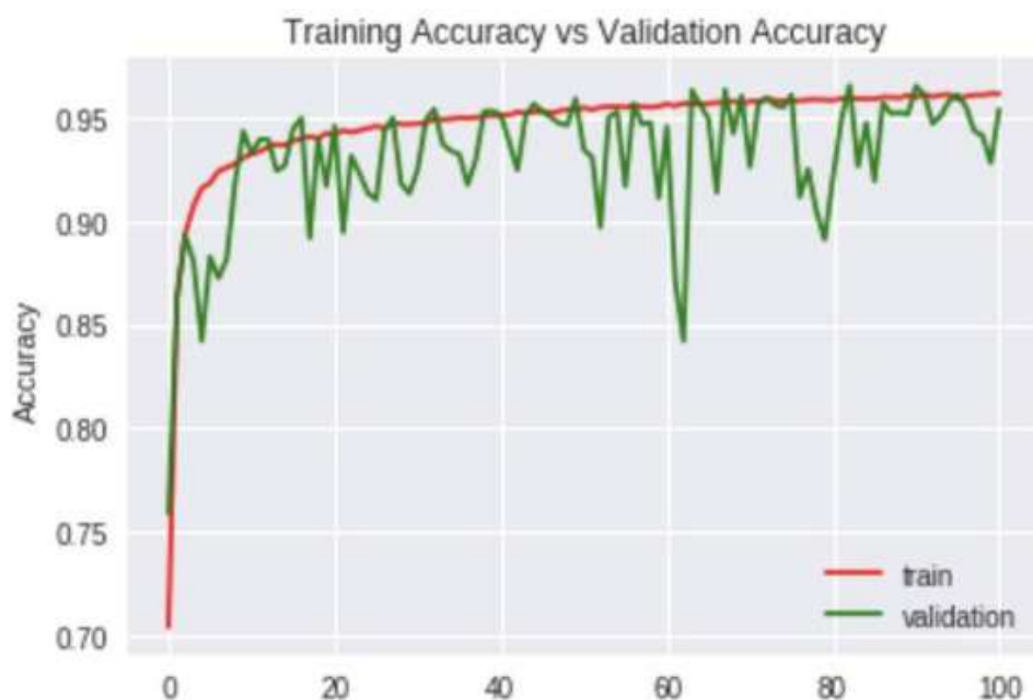
Рисунок 3.18 – Тренування на зашумленому імпульсом ЕМГ сигналі ЕКГ CNN
