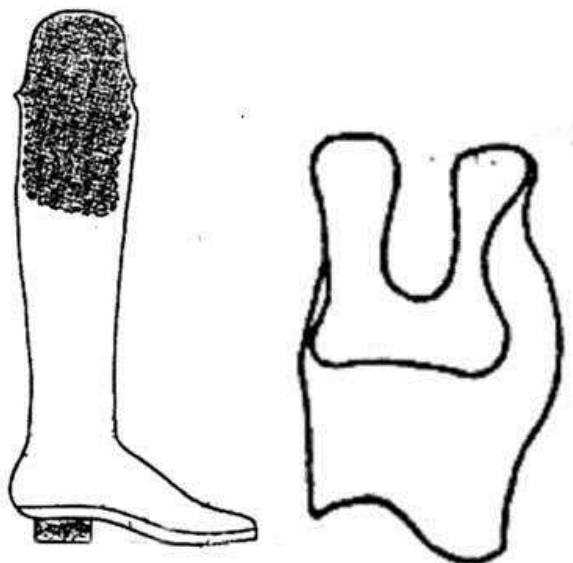
Рисунок 4.20 – Схема протезу гомілки та приймальна гільза з глибокою посадкою типу РТК
