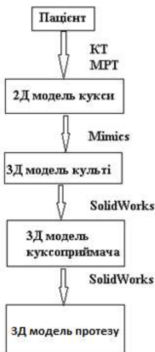
Рисунок 4.1 – Схематичне зображення технології формування цифрової 3D моделі геометрії культі
