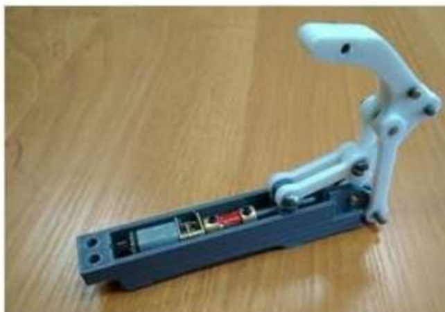
Рисунок 1.8. – Модель пальця руки, що працює на черв'ячній передачі
