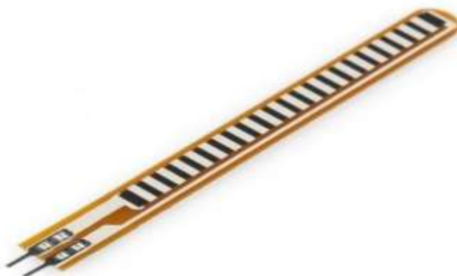
Рисунок 1.10 – Датчик вигину Sparkfun
