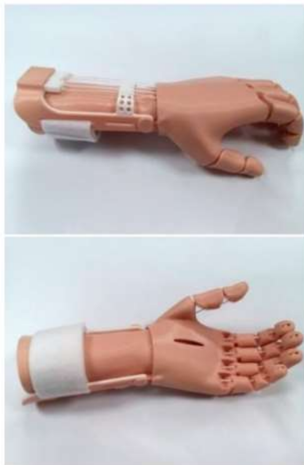
Рисунок 3.1 – Конструкція робототехнічної руки на основі тяги
