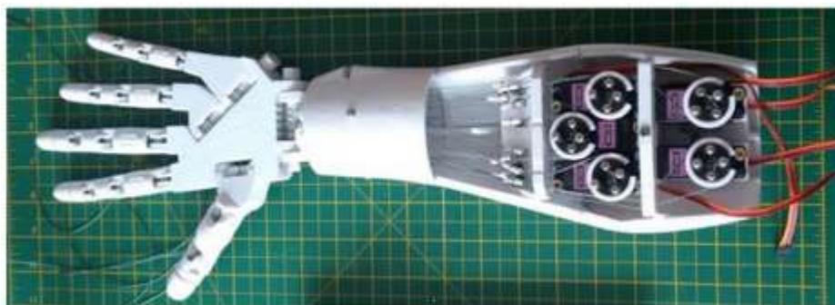
Рисунок 7.2 – Зібрана конструкції передпліччя руки
