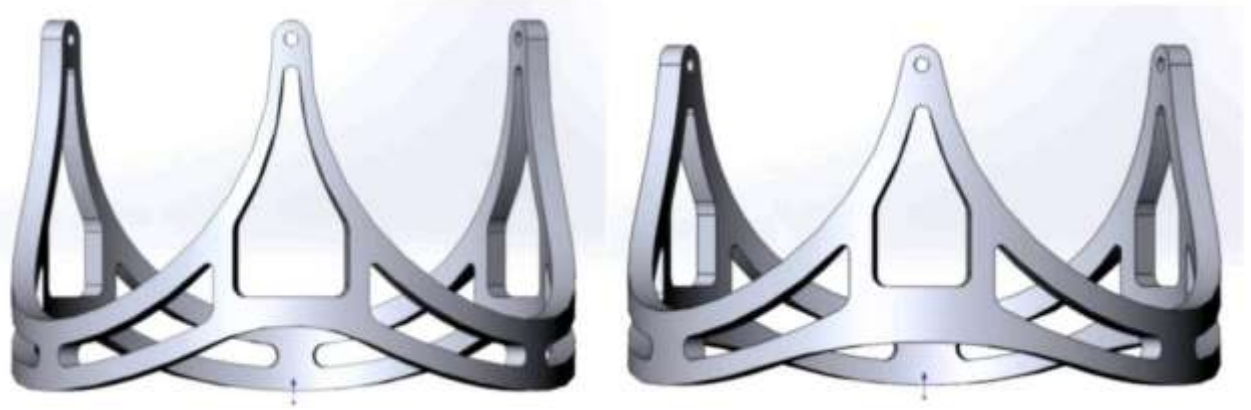
Рисунок 2.2 — 3D моделі шаблонів каркасів з однаковими параметрами (діаметром і товщиною), що відрізняються формами профілю, які побудовані в SolidWorks
