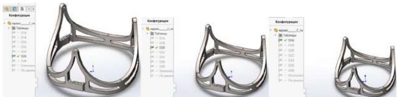
Рисунок 2.9 — Каркаси з динамічними розсувними механізмами, число в назві конфігурації відображає їх зовнішній діаметр в мм
