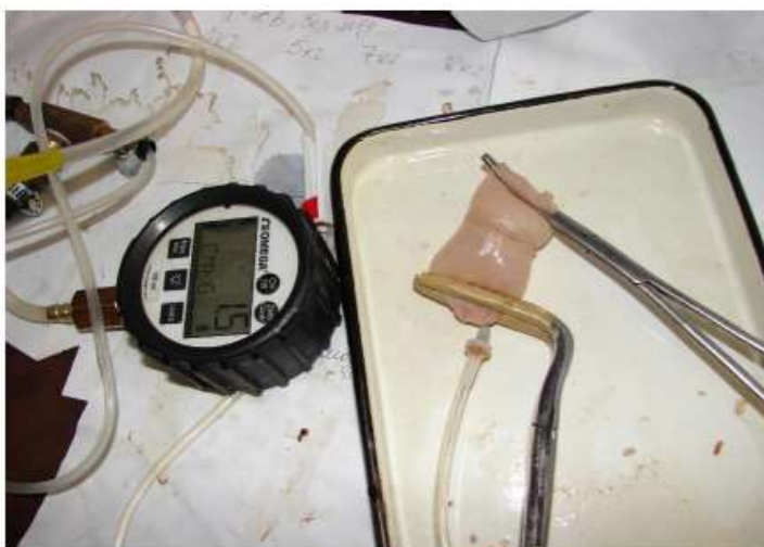
Рисунок 2.1 – Дослідження міцності зварного шва при радіальному розтягу
