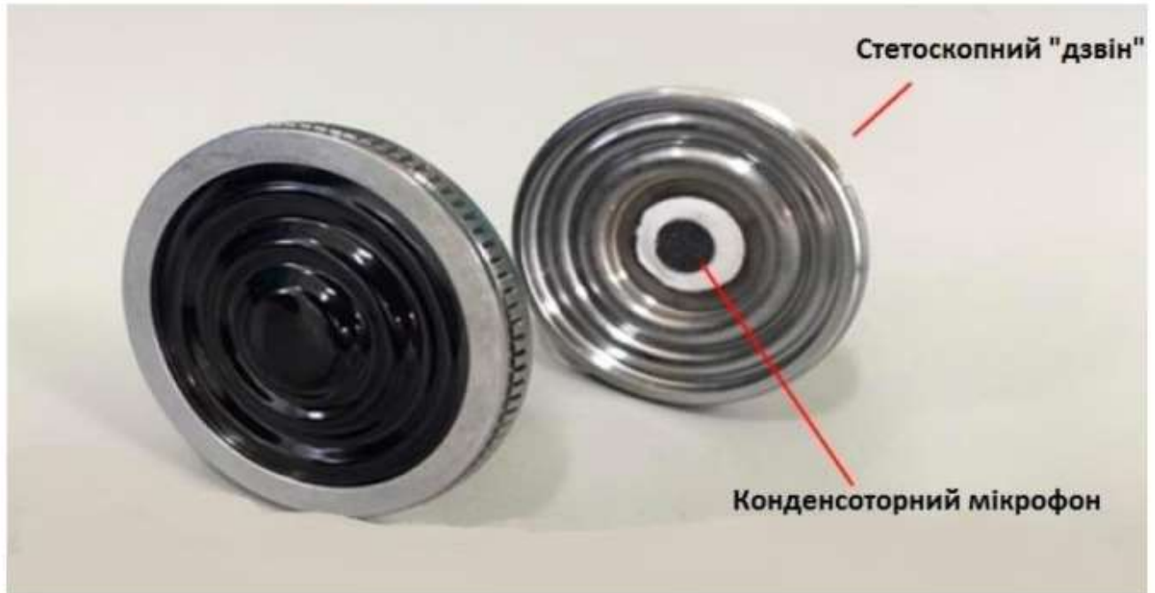
Рисунок 4.2 - Акустичний датчик бездротового модуля шумів дихання.
