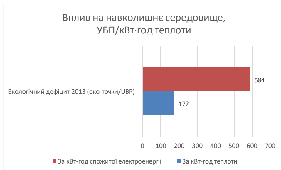
Рисунок 2.33 - Показники роботи теплового насоса «стічні води-вода» для значення локального коефіцієнта ефективності 4
