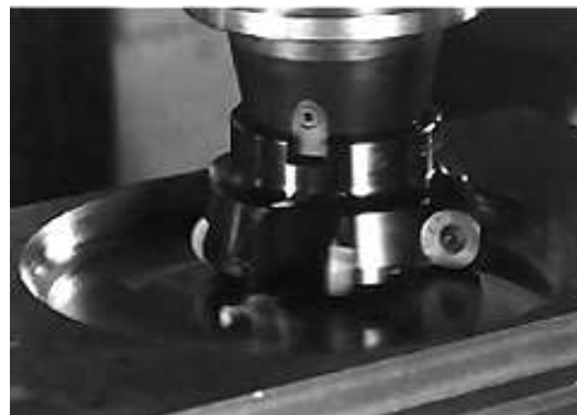
Рисунок 1.1 - . Торцеві фрези конструкції фірми Sumitomo Electric
