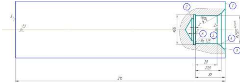
Рисунок 2.7 – Ескіз чорнових технологічних баз
