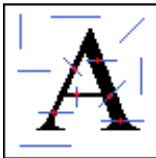
Рисунок В.2 – Метод отримання ознак текстового символу на основі лінійних сенсорів
