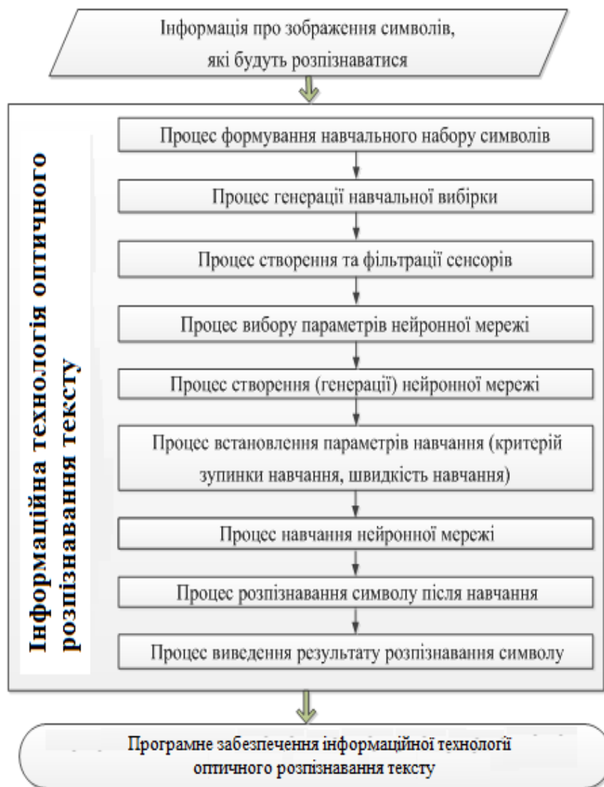
Рисунок В.3 – Структура інформаційної технології оптичного розпізнавання тексту
