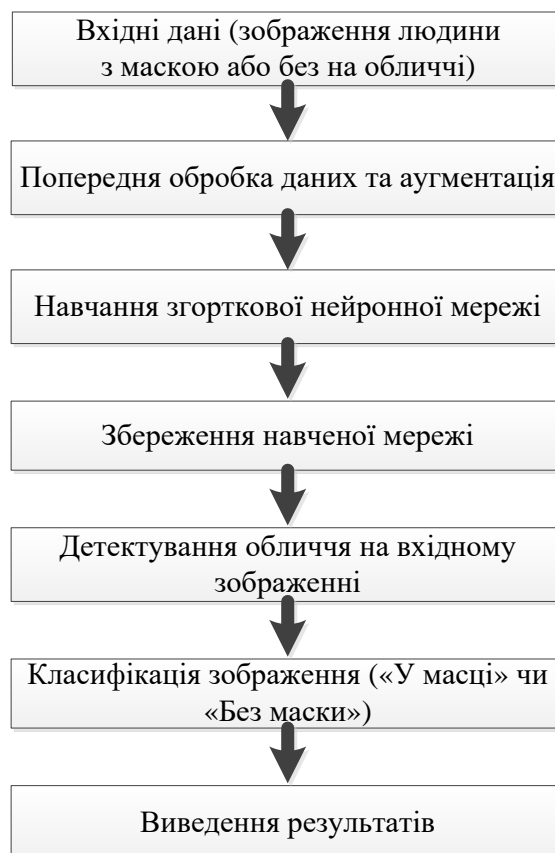
Рисунок 2.1 – Структура інформаційної технології розпізнавання медичних масок на обличчі на основі згорткової нейромережі
