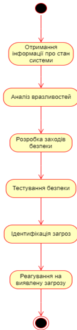
Рисунок 3.12 – UML-діаграма удосконаленого алгоритму функціонування модуля аналізу безпеки
