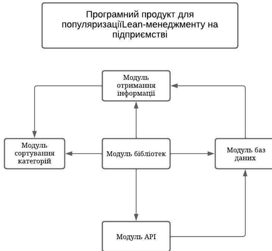
Рисунок 3.2 – Структура серверної частини програмного забезпечення для управління проектами
