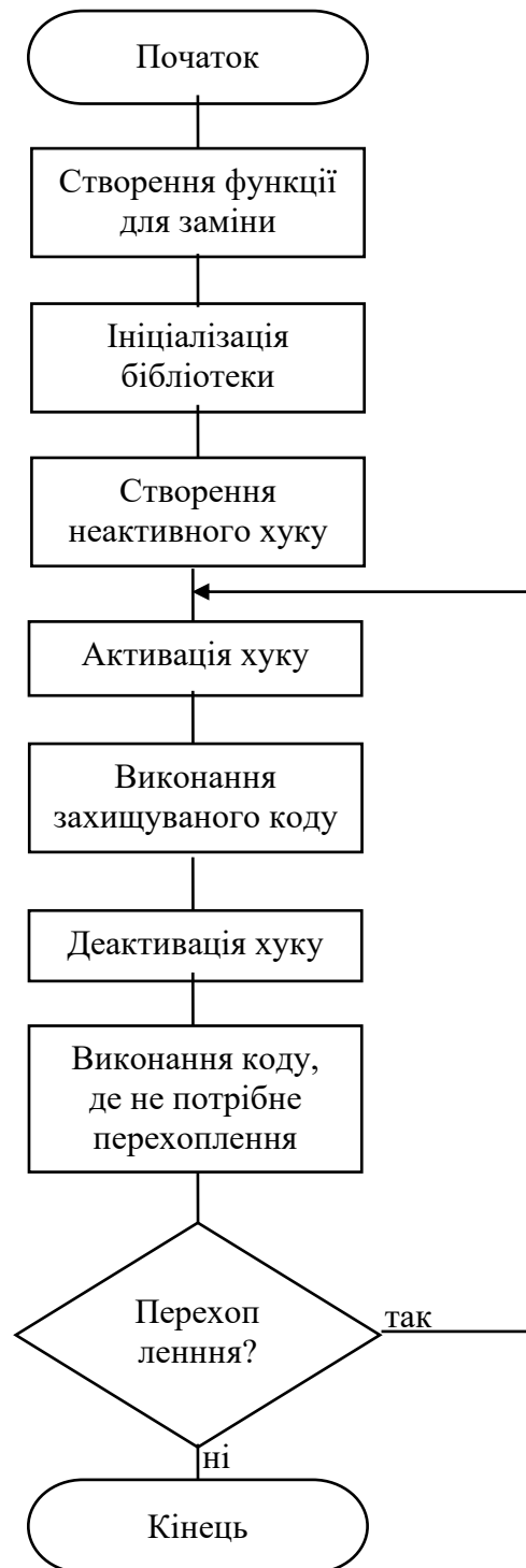
Рисунок 2.3 – Алгоритм перехоплення функцій копіювання пам'яті
