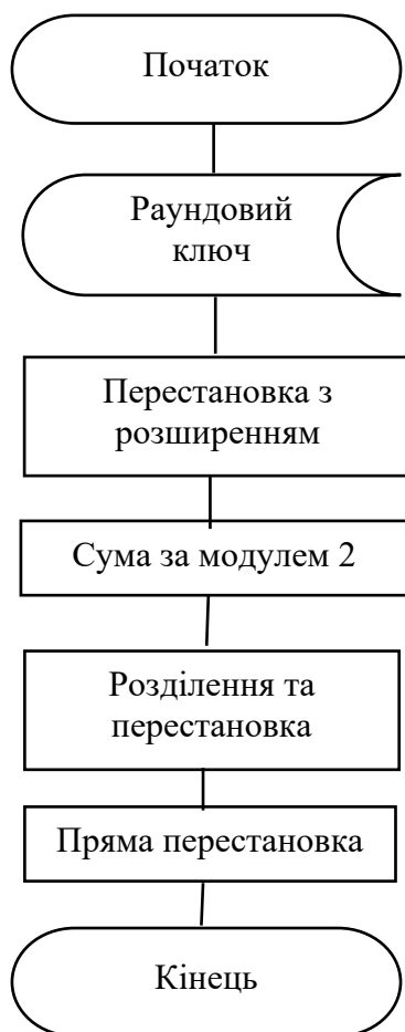
Рисунок 2.2 – Алгоритм роботи раундової функції
