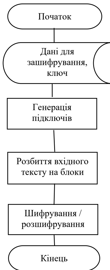
Рисунок 3.10 – Алгоритм процедури шифрування / розшифрування
