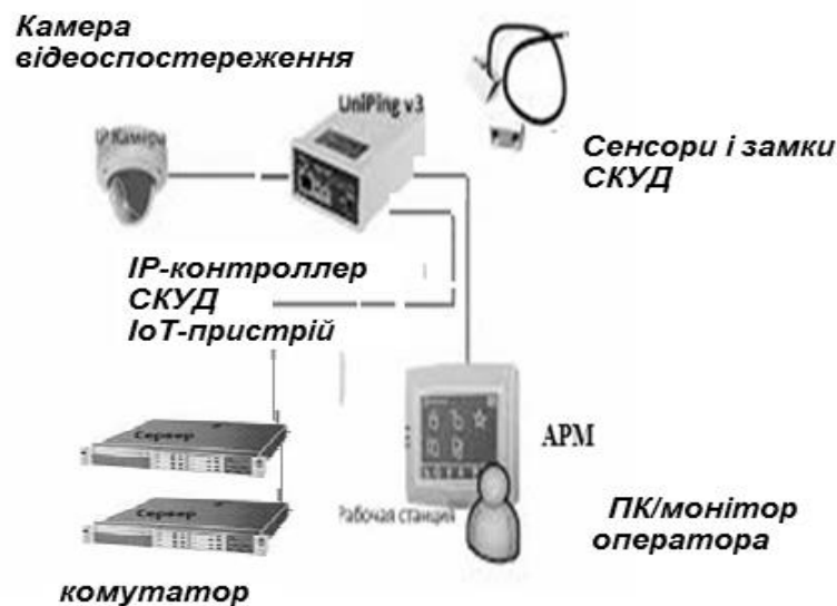
Рисунок 1.11 – Схема інформаційного кластеру мережі СКУД на базі контролера IoT із консоллю контролю зон доступу СКУД
