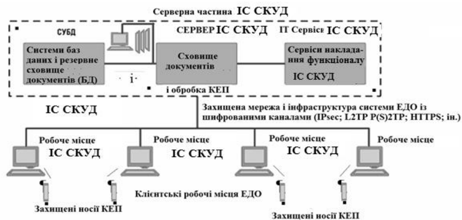
Рисунок 3.3 – Структура ІС СКУД, яка інтегрована в ІТ інфраструктуру
