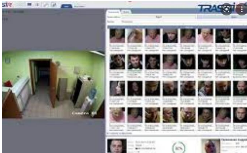
Рисунок 1.12 – Зовнішній вигляд консолі та інтерфейсу ПЗ СКУД із функцією відеоспостереженні контролю доступу в зоні N на базі контролера IoT в зоні
