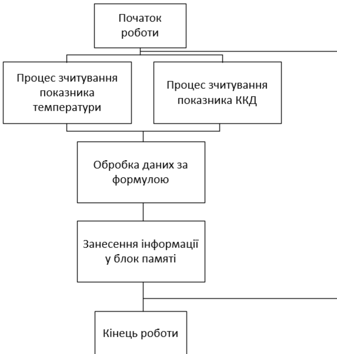
Рисунок 2.5 . Цикл роботи програми розрахунку ефективності за ККД та температурою
