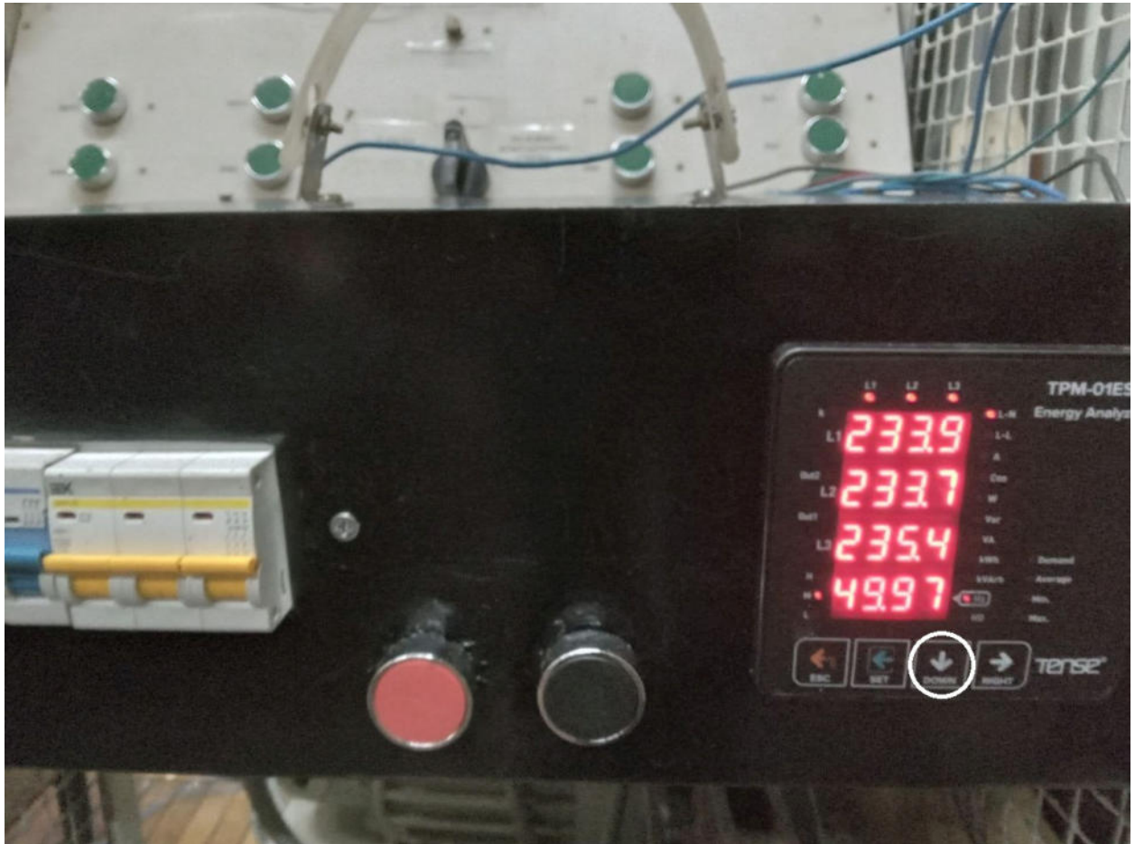
Рисунок 6.10 – Кнопка для переходу на наступний параметр для вимірювань
