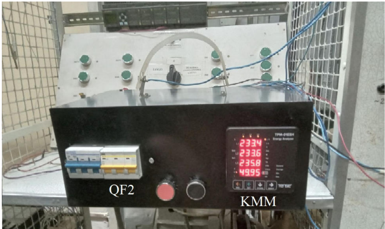
Рисунок 6.8 – Початок роботи аналізатора параметрів мережі після запуску другого автоматичного вимикача QF2
