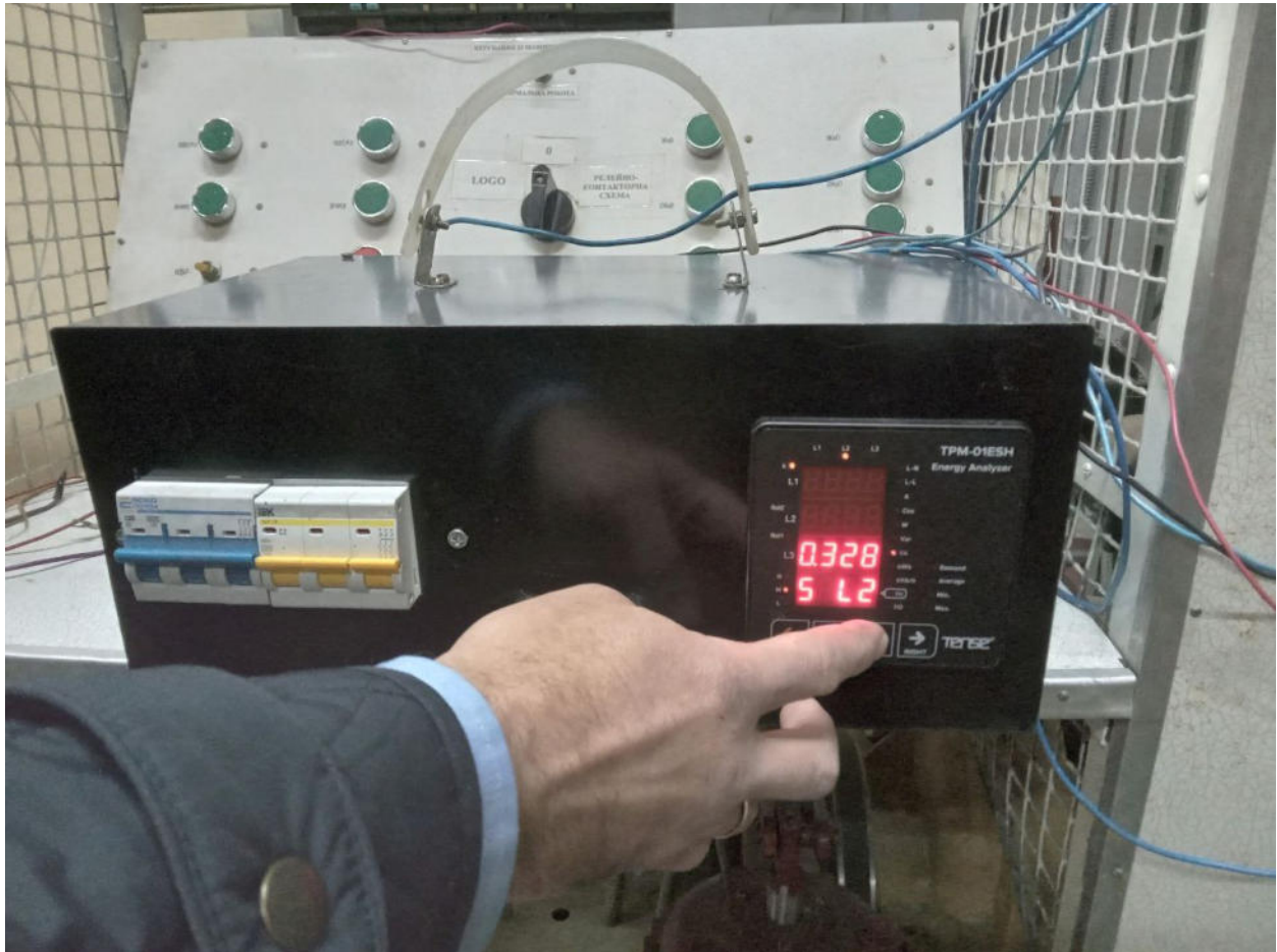
Рисунок 6.14 – Демонстрація вимірних параметрів повної потужності для другої лінії
