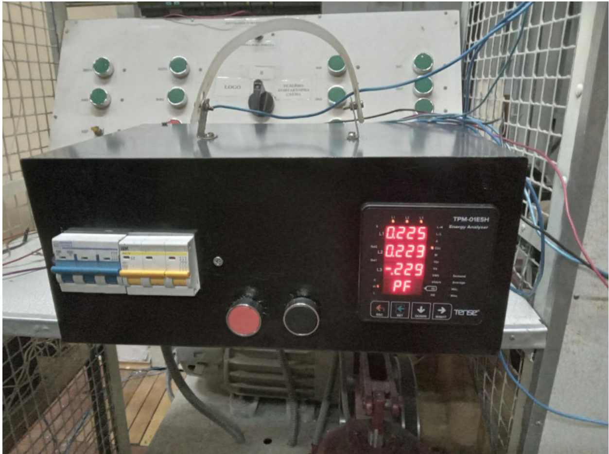
Рисунок 6.14 – Демонстрація вимірних параметрів \cos\phi коефіцієнту потужності
