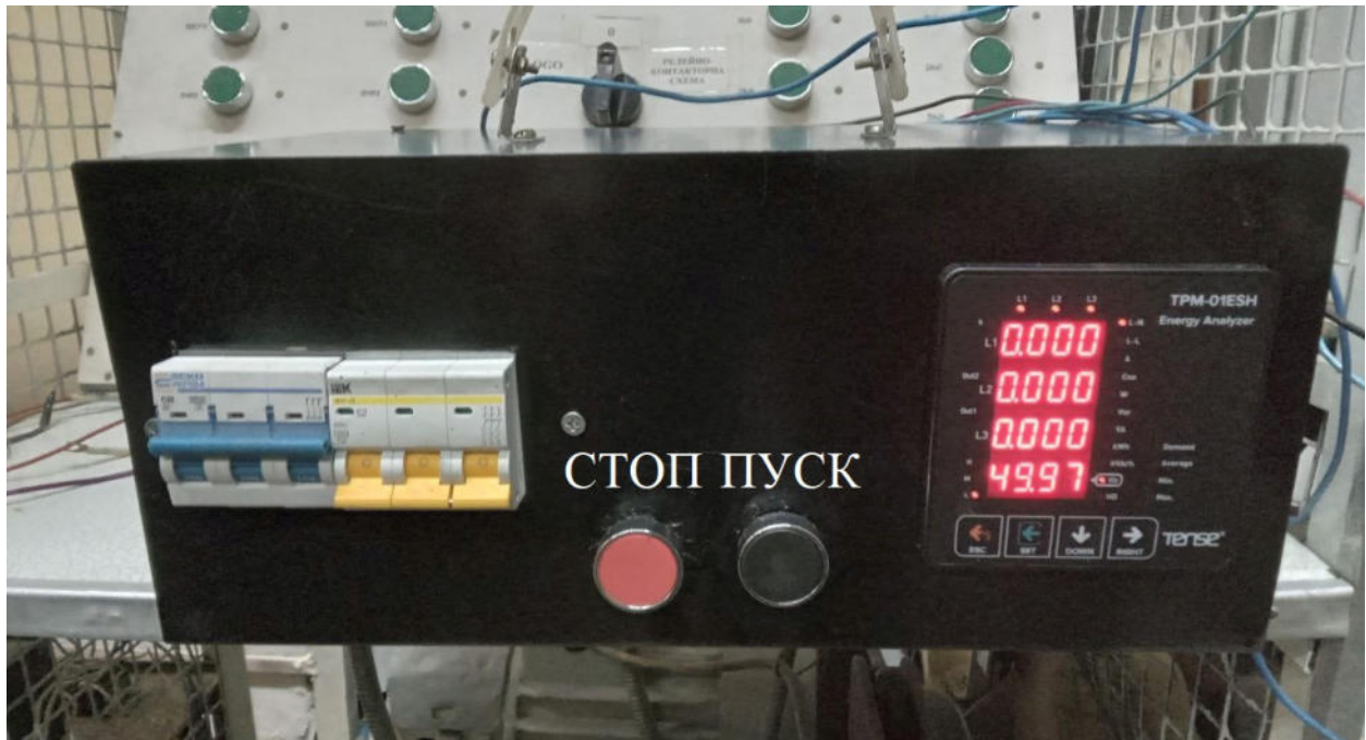
Рисунок 6.7 – Кнопки ПУСК та СТОП для запуску та вимкнення двигуна
