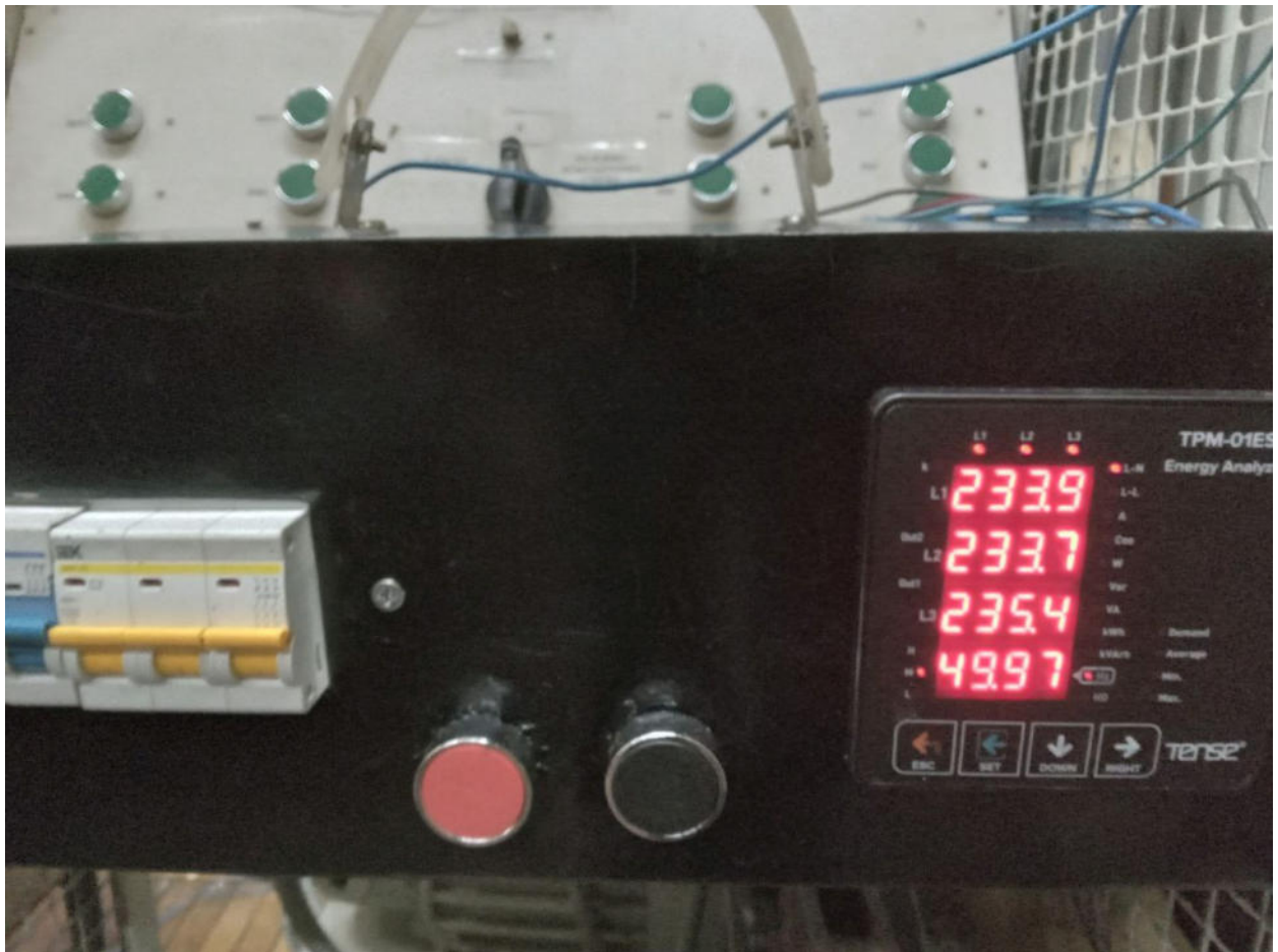
Рисунок 6.9 – Демонстрація вимірювань напруги аналізатором параметрів
