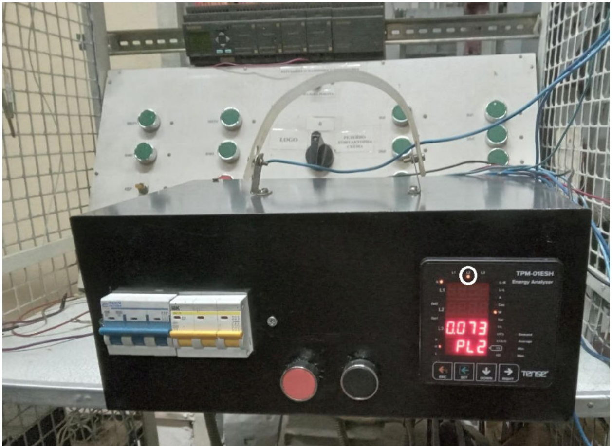
Рисунок 6.12 – Зміна лінії з першої на другу та демонстрація вимірних параметрів активної потужності другої лінії на дисплеї аналізатора
