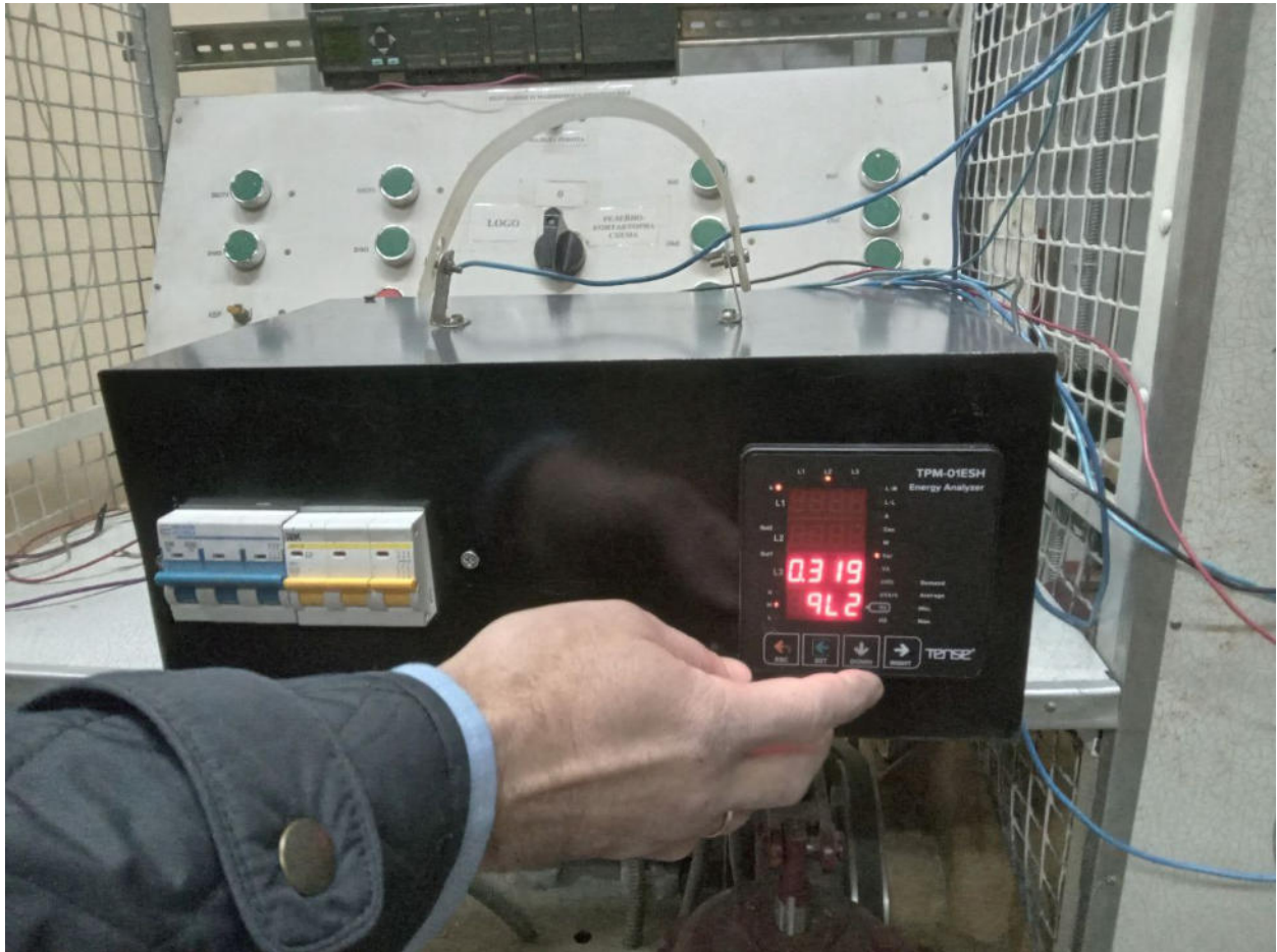
Рисунок 6.13 – Демонстрація вимірних параметрів реактивної потужності для другої лінії
