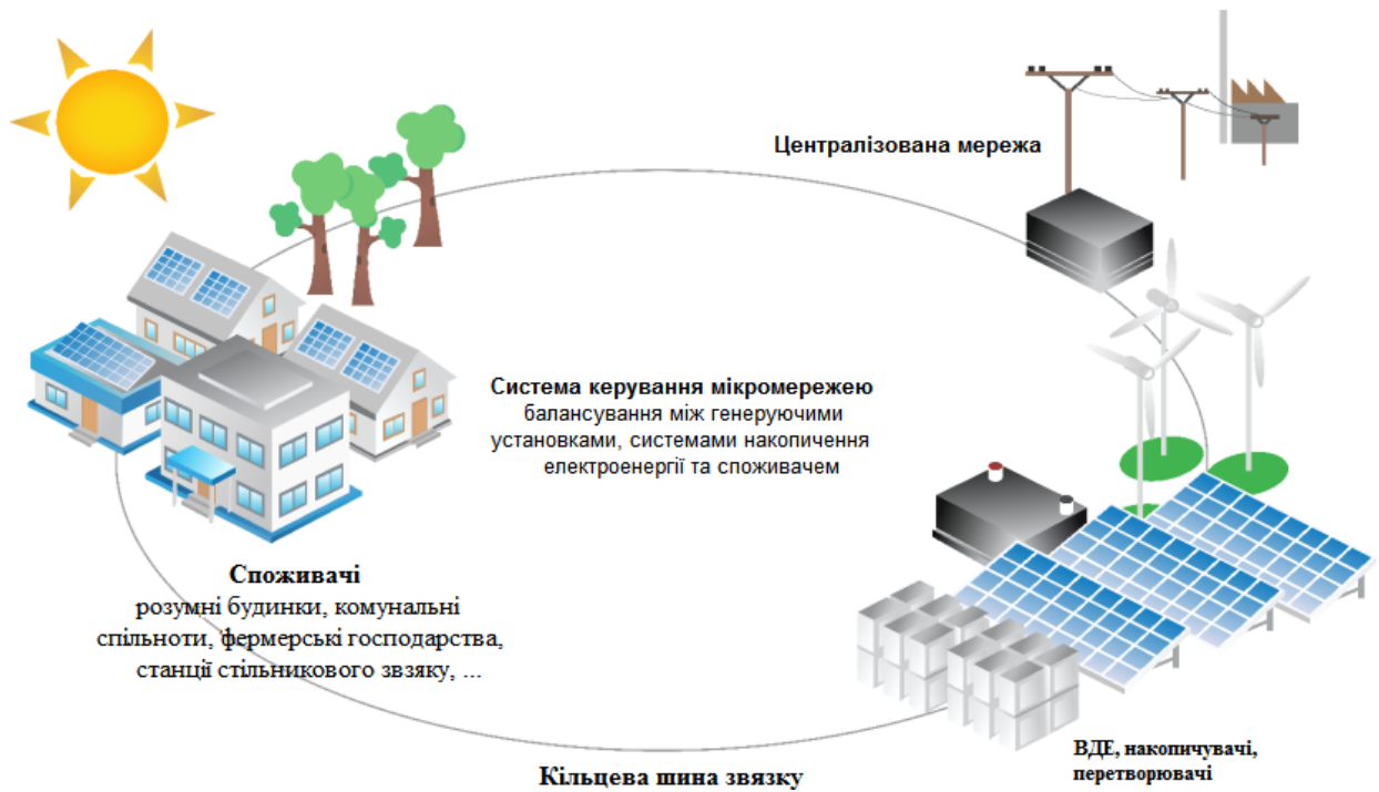
Рисунок 1.1 – Блок-схема реалізації концепції мікромережі
