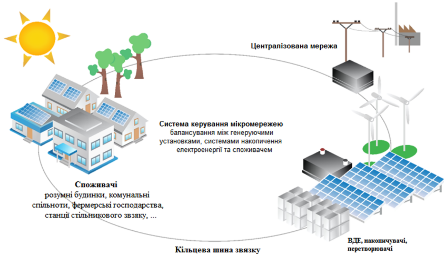
Рисунок 5 – Прикладом концепції Smart Grid - Microgrid
