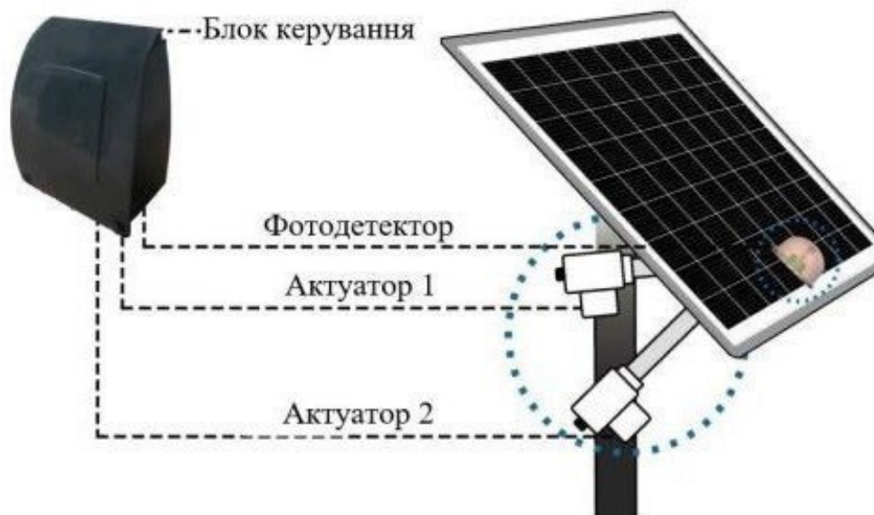
Рисунок 1.8 – Система керування на фотоприймачах
