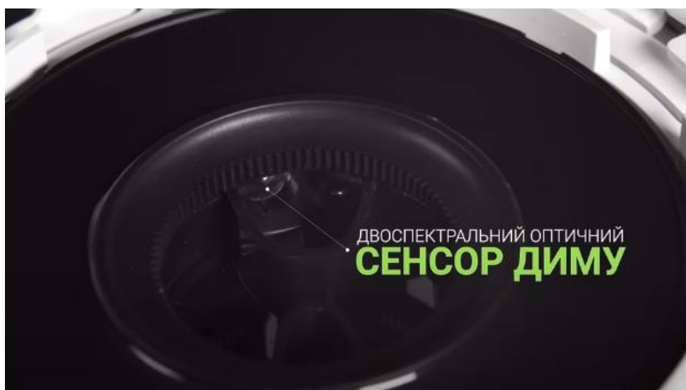
Рисунок 1.2 - Двоспектральний оптичний датчик диму Ajax FireProtect 2
