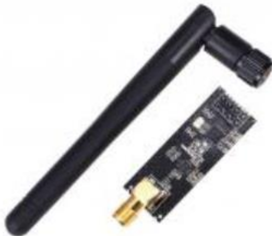
Рисунок 4.4 - Модуль зв'язку NRF24L01+PA+LNA з підсилювачем сигналу.
