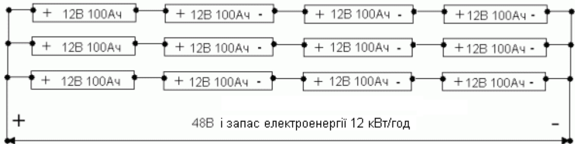
Рисунок 8.8 – Схема з'єднання батарей.
