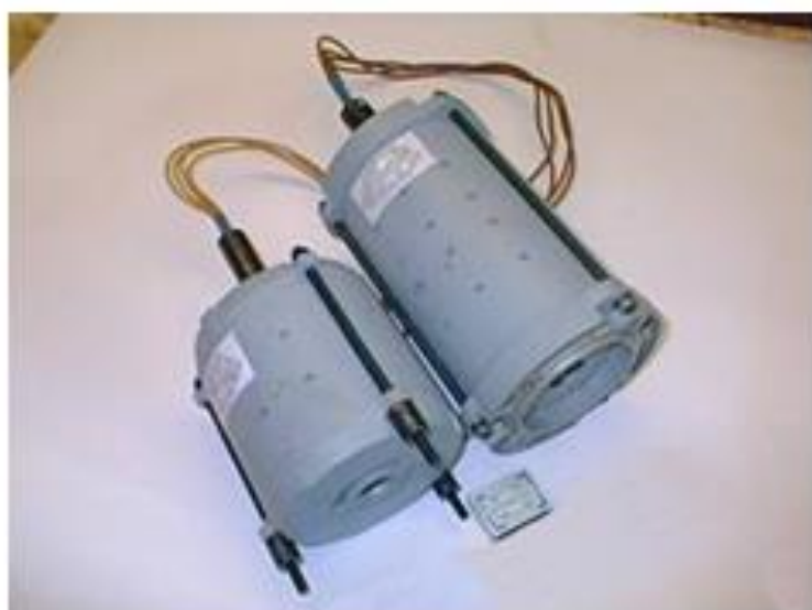
Зовнішній вигляд генератора ВГ-1(12)450
