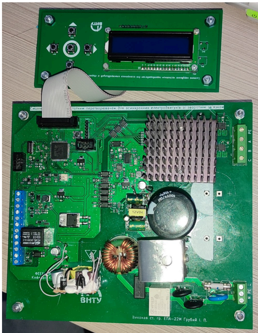
Рисунок 4.22 – Силова (внизу) та НМІ (вгорі) плати СКАД на базі ПЧ
