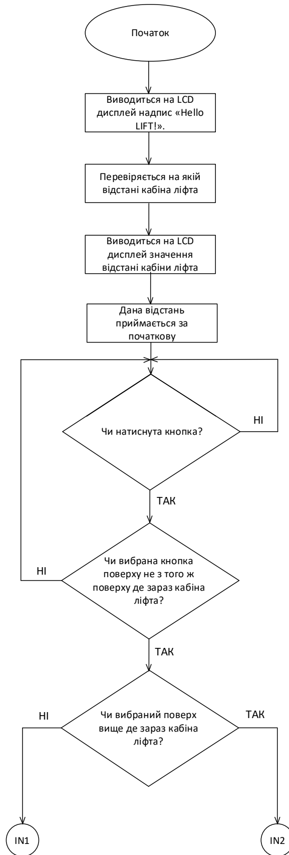
Рисунок 3.2 – Алгоритм роботи лабораторного стенда для імітації роботи електромеханічної частини підйомної установки з функцією моніторингу стану системи
