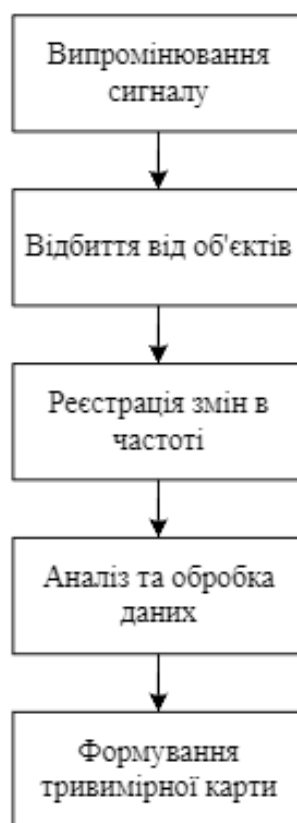
Рисунок 1.4 – Принцип роботи сенсору AWR2944
