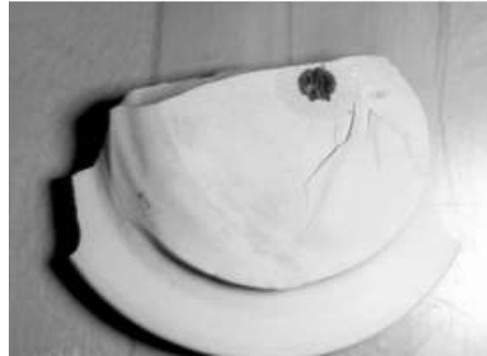
б) крупний зосереджений дефект в опорно-стрижневому ізоляторі, зумовлений металевим (Fe) включенням
