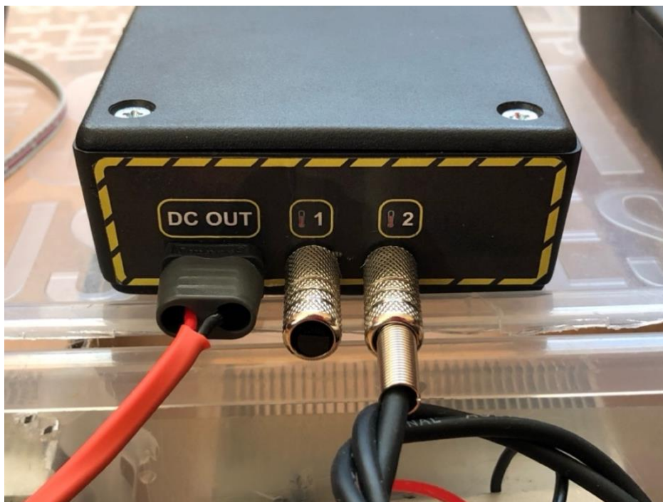
Рисунок 2.9 – навісний модуль контролю системи нагрівачів - порт виходу/зчитування температури з зовнішніх датчиків
