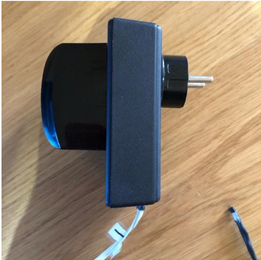
Рисунок 2.7 – модуль контролю системи нагрівачів з послідовним підключенням нагрівача – вигляд збоку
