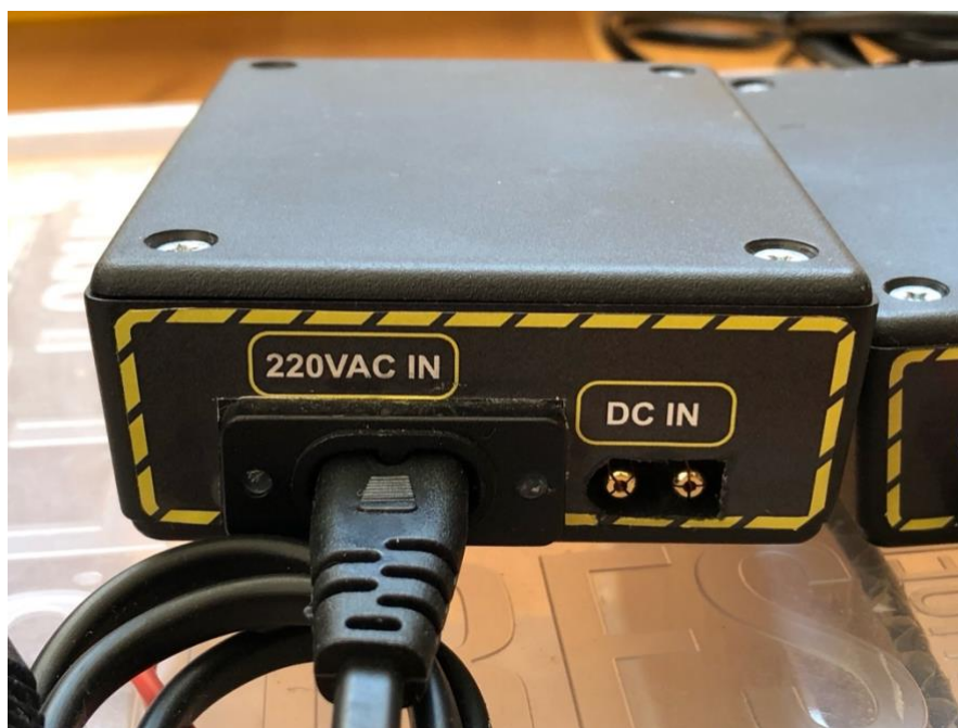
Рисунок 2.10 – модуль контролю системи нагрівачів - порти входу
