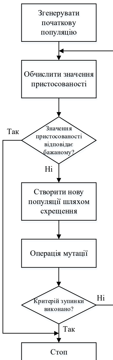
Рисунок 5.3 Блок-схема розробленого генетичного алгоритму
