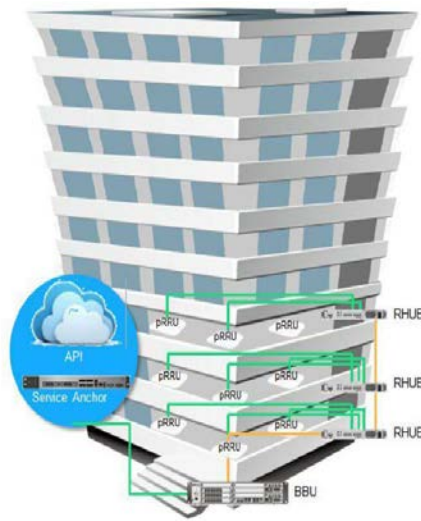
Рисунок 1.6 – Схема з'єднання мережі 5G Indoor
