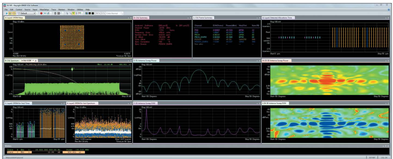
Рисунок 2.2 – Аналіз сигналів стандарту 5G NR з модуляцією 256 QAM і діаграми спрямованості антен
