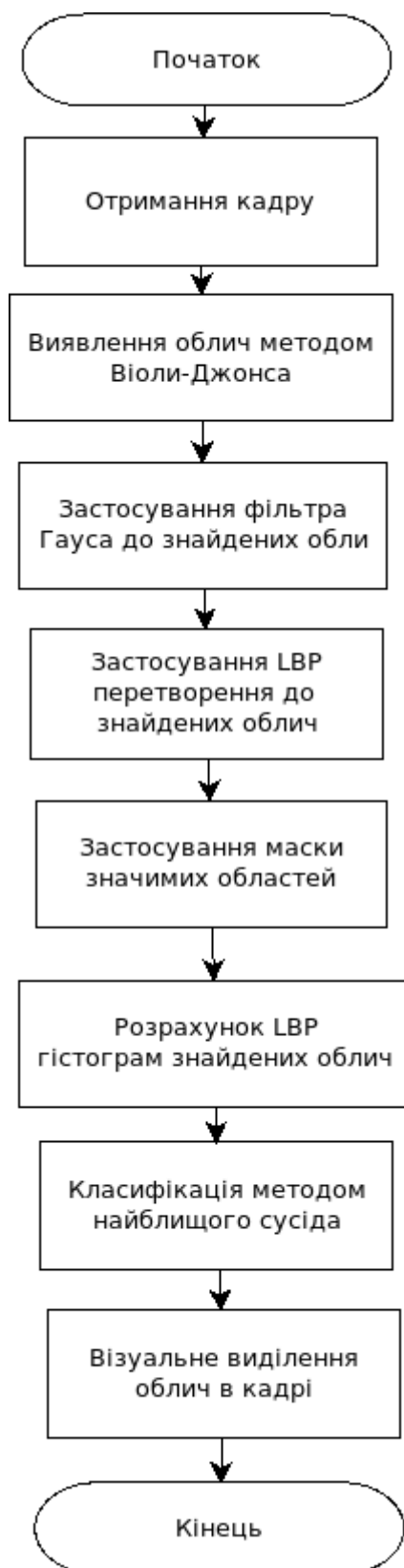
Рисунок Б.1 - Схема алгоритма обробки кадрів відеопотока
