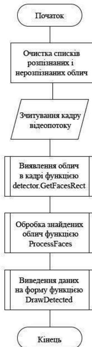
Рисунок 3.6 - Схема алгоритма обробки кадрів у відеопотоці Draw Detected
