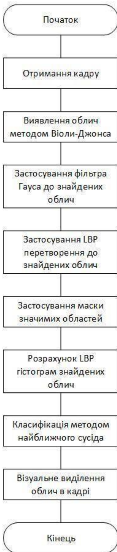
Рисунок 1.2 - Схема алгоритма обробки кадрів відеопотока
