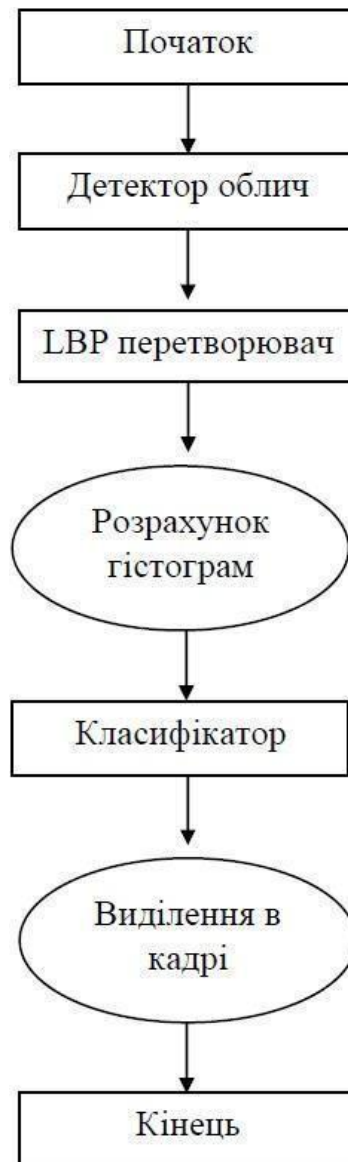
Рисунок 3.1 - Схема аналізу потоків даних у системі
