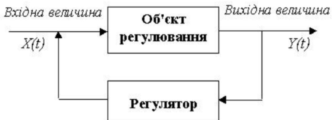
Рисунок 1.2 - Функціональна схема САР.
