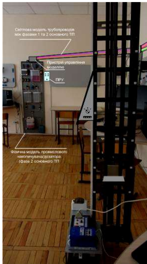
Рисунок 1.11 - Імітаційна модель рідких матеріальних потоків (трубопроводів) між фазами 1 і 2 основного ТП
