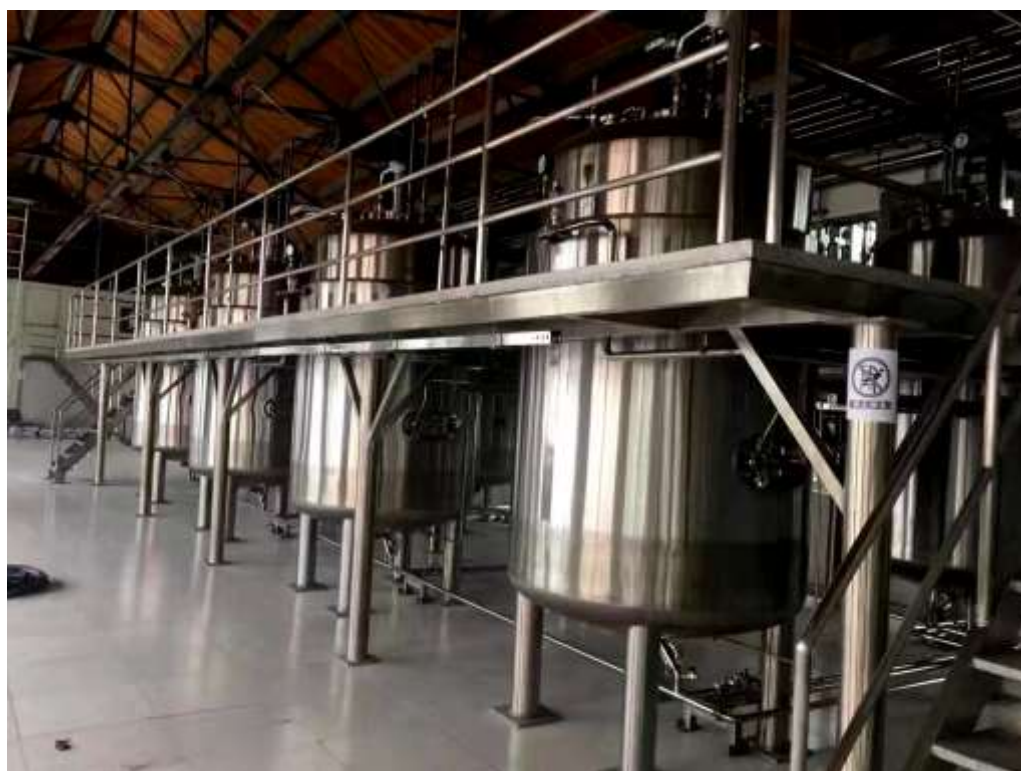
Рисунок 4.6 – Система «розумних» хімічних реакторів невеликого об'єму
