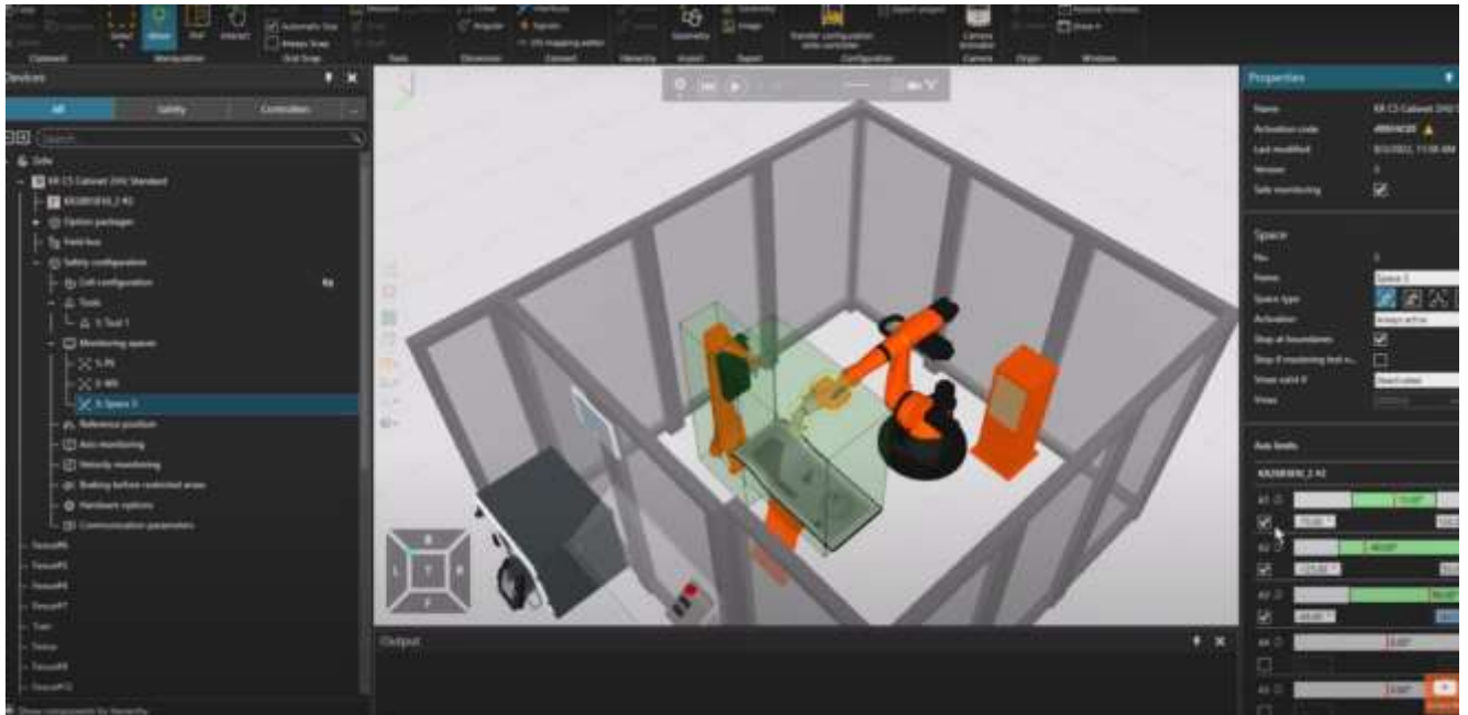
Рисунок 1.18 – Наладка через цифрову модель зони безпеки
