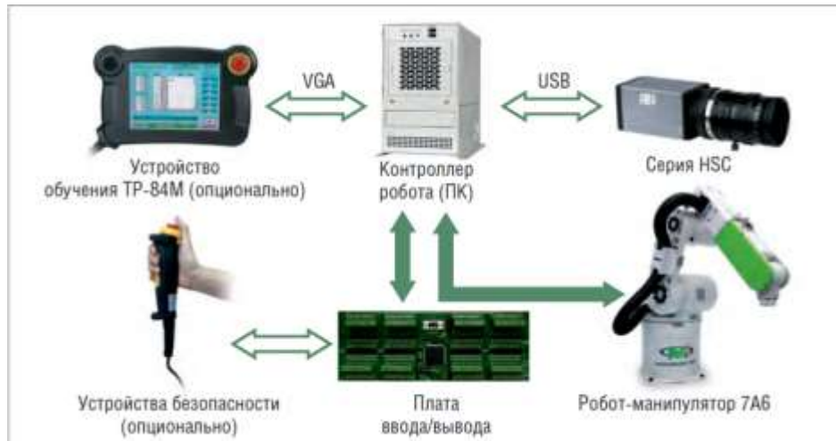
Рисунок 1.13 – Архітектура системи точного переміщення виробу
