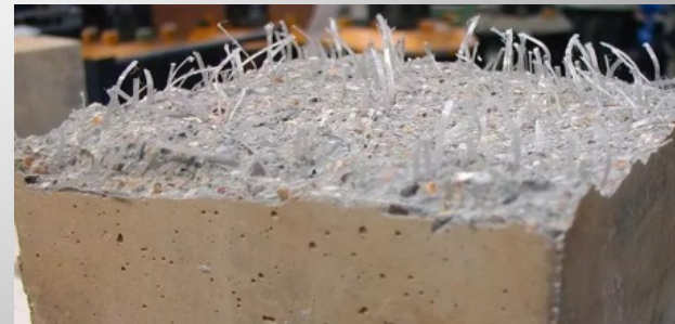
Характер руйнування зразків фібробетону із базальтовим волоком
