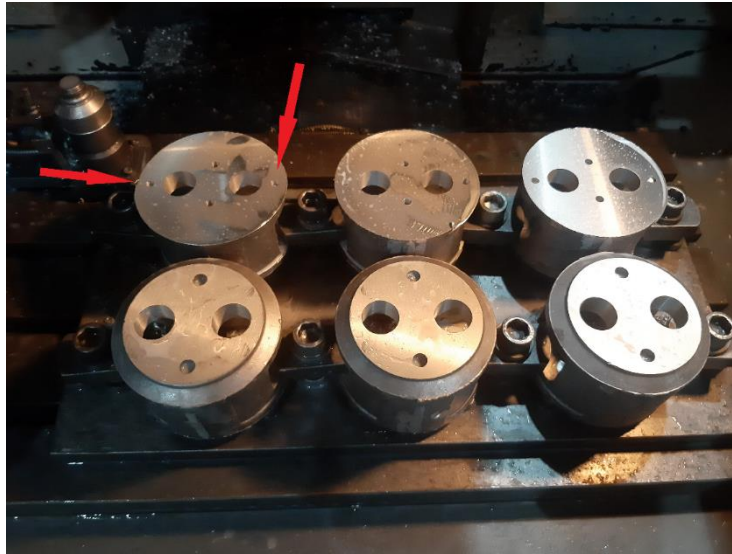
Рисунок 2.3 – Виготовлення базових отворів
