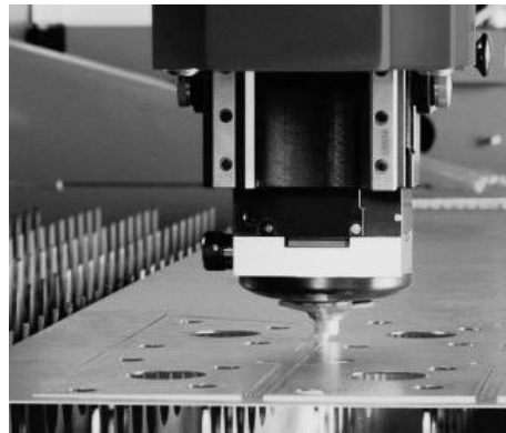
Рисунок 2.3 – Лазерне вирізання листового матеріалу
