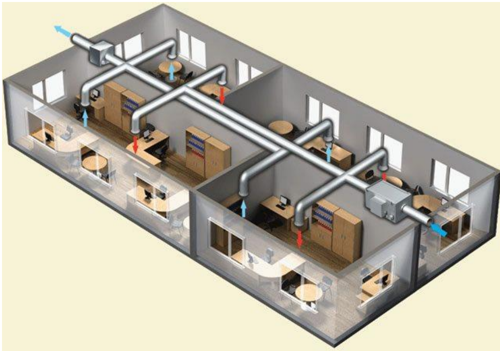
Рисунок 1.10 – Вигляд припливно-витяжної системи вентиляції приміщень
