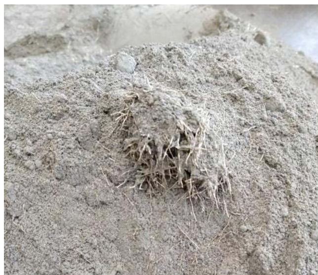
Рисунок 3.3 – Приготування бетонної суміші з металевою фіброю
