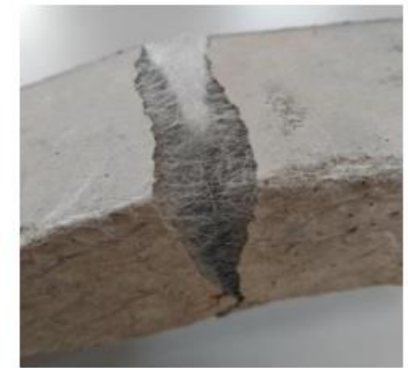
Рисунок 4 — Границя міцності та характер руйнування зразків на розтяг при згині:
