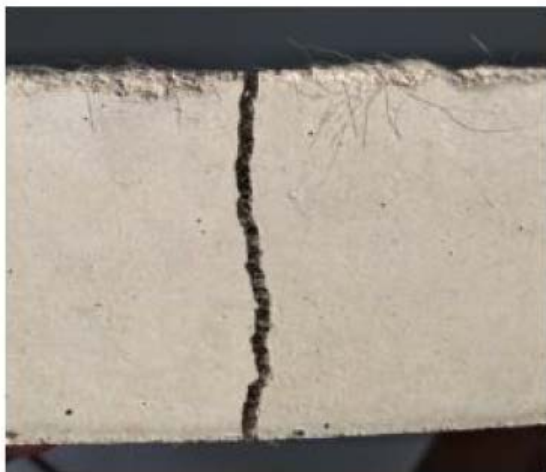
Рисунок 3.6 – Границя міцності та характер руйнування зразків на розтяг при згині
