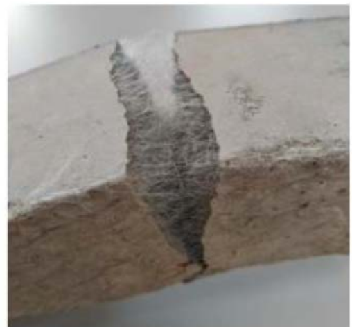
Рисунок 3.6 – Границя міцності та характер руйнування зразків на розтяг при згині
