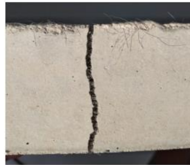
Рисунок 4 — Границя міцності та характер руйнування зразків на розтяг при згині:
