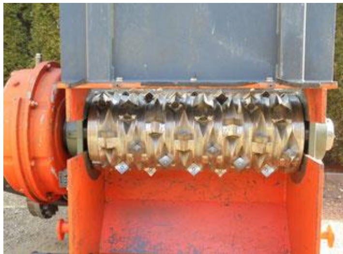
Рисунок 2.12 – Подрібнювач типу V-Rotor компанії Weima
