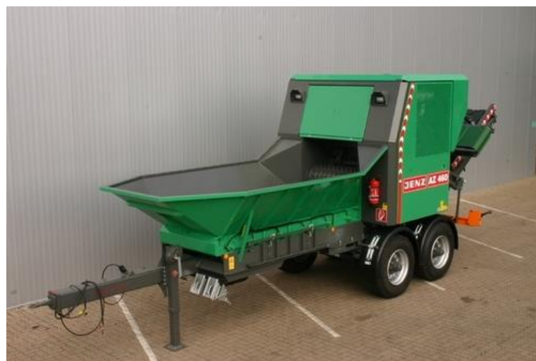
Рисунок 2.16 – Зовнішній вигляд мобільного молоткового подрібнювача
