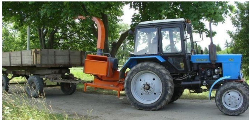
Рисунок 2.15 – Зовнішній вигляд подрібнювача RM 800.5 приєднаного до трактора
