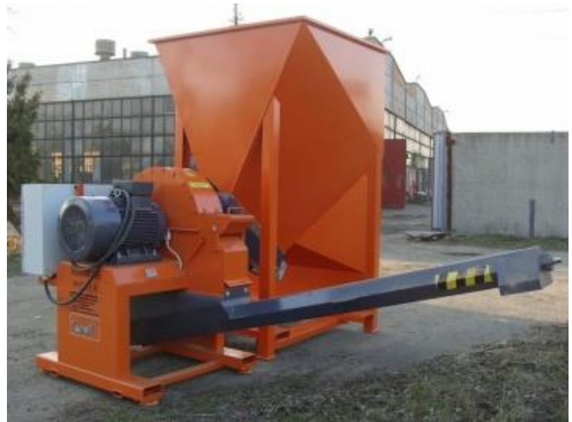
Рисунок 2.17 – Барабанний подрібнювач WLH фірми Weima (Німеччина) ( a ) та молотковий подрібнювач Хеммель (Україна) RM 71
