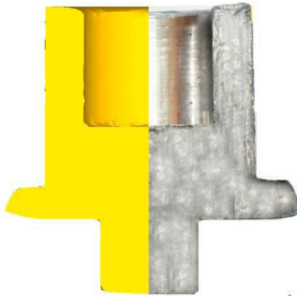
Рисунок 3.11 – Зміни геометрії напівфабрикату із С1 отримані на основі експерименту та методом кінцевих елементів
