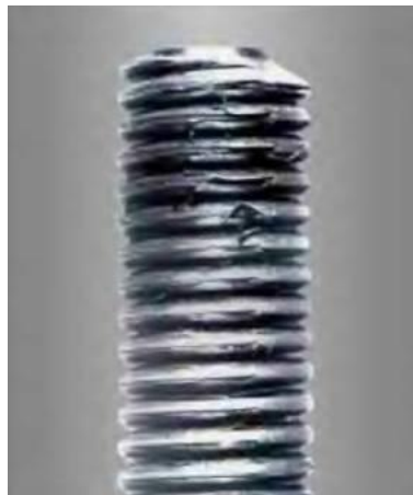
Рисунок 4.4 – Відшарування на ділянці різьблення при накатуванні в місці нанесення ризику на заготовку
