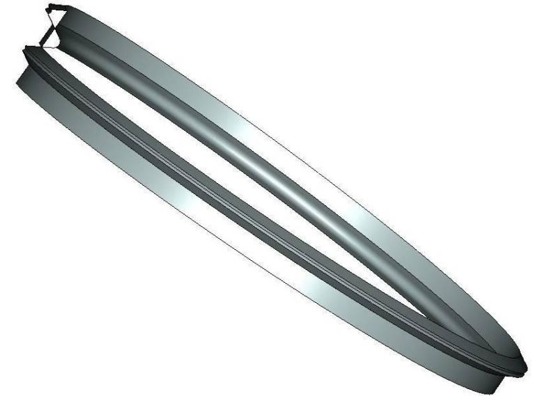
Рисунок 27. Визначення діаметра заготовки під накочуванням різьблення M20x1,5 за допомогою 3D моделювання
