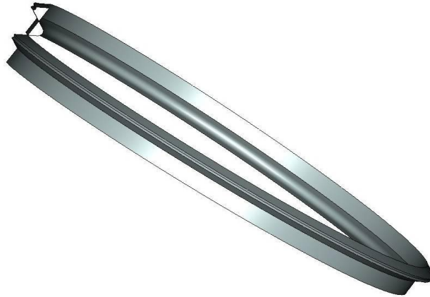
Рисунок 4.3 – Визначення діаметра заготовки під накочуванням різьблення M20x1,5 за допомогою 3D моделювання
