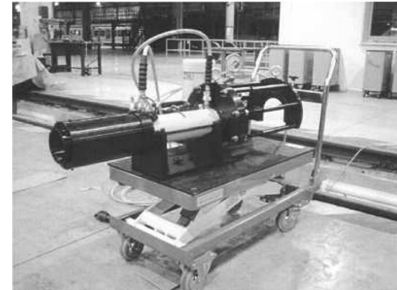
Рисунок 2 – Гідравлічний прес двохсторонньої дії SKF 1652058-100/A1 (а) і оснастка до нього для демонтажу касетних підшипників бруксових вузлів (б)
