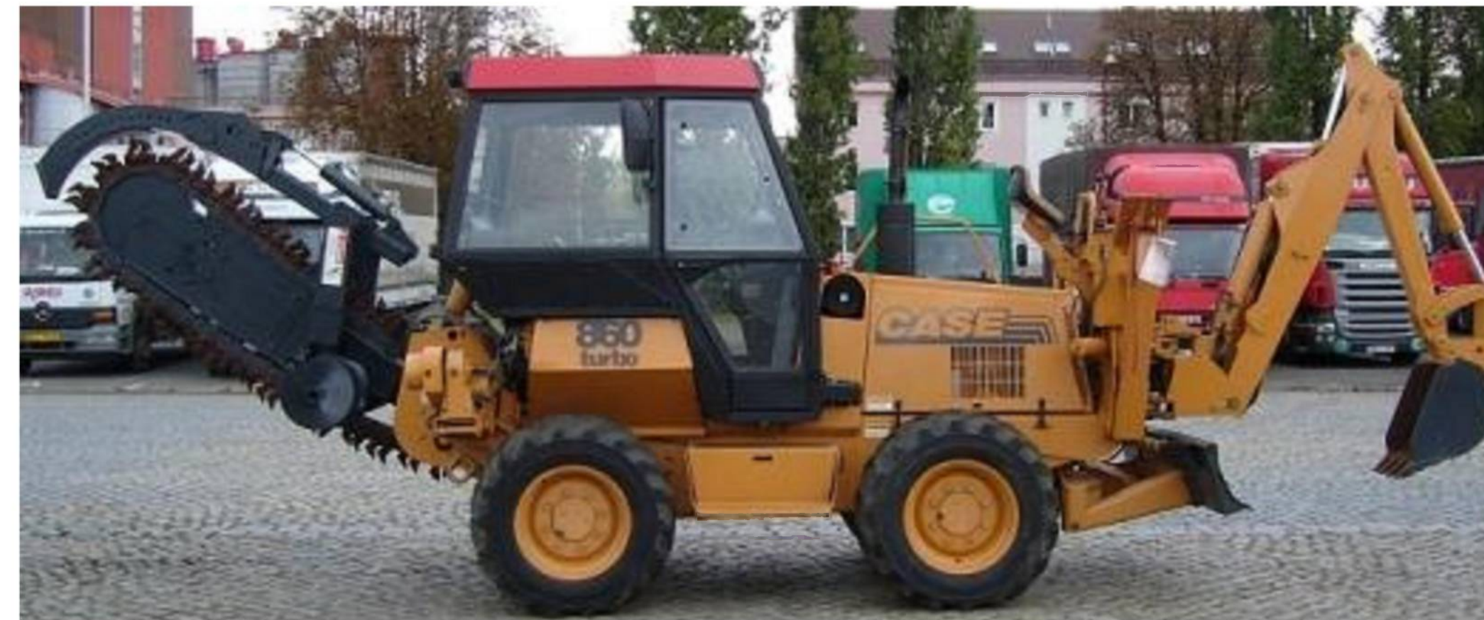
Рисунок 4 – Case 860 Turbo H_k=120-150\text{мм} , b=20\text{мм}
