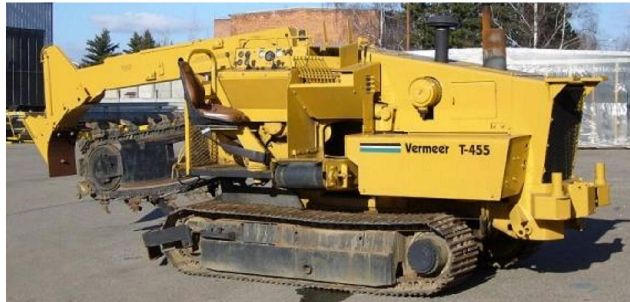
Рисунок 2 – Vermeer T455 H_k=120\text{мм} , b=40\text{мм}
