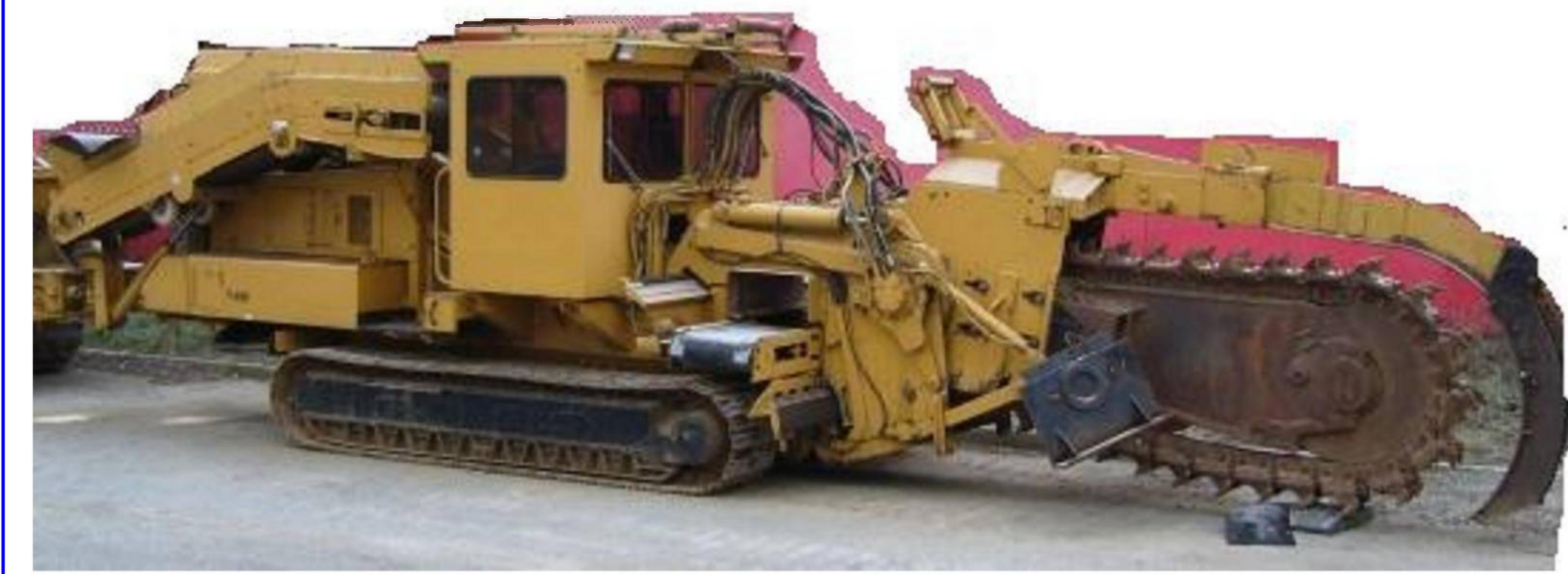
Рисунок 1 – Vermeer T658 H_k=180\text{мм} , b=48\text{мм}
