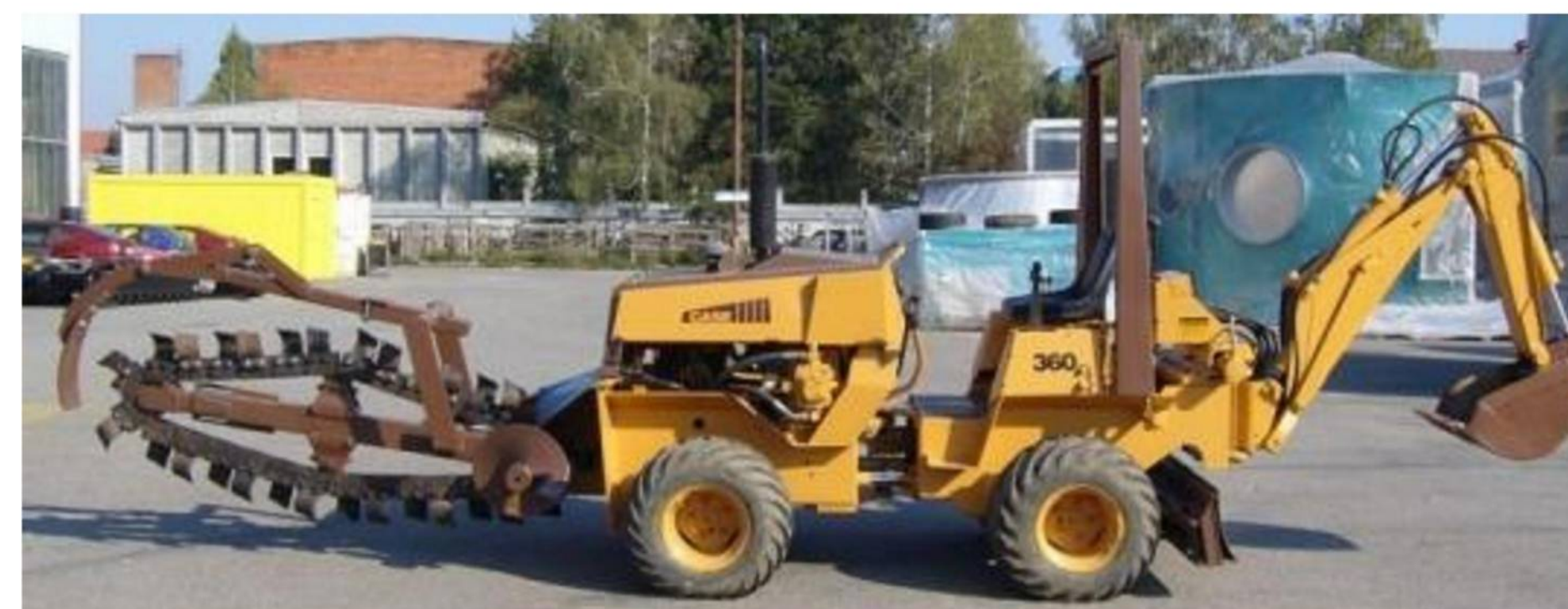
Рисунок 7 – Case 360 H_k=120\text{мм} , b=20\text{мм}
