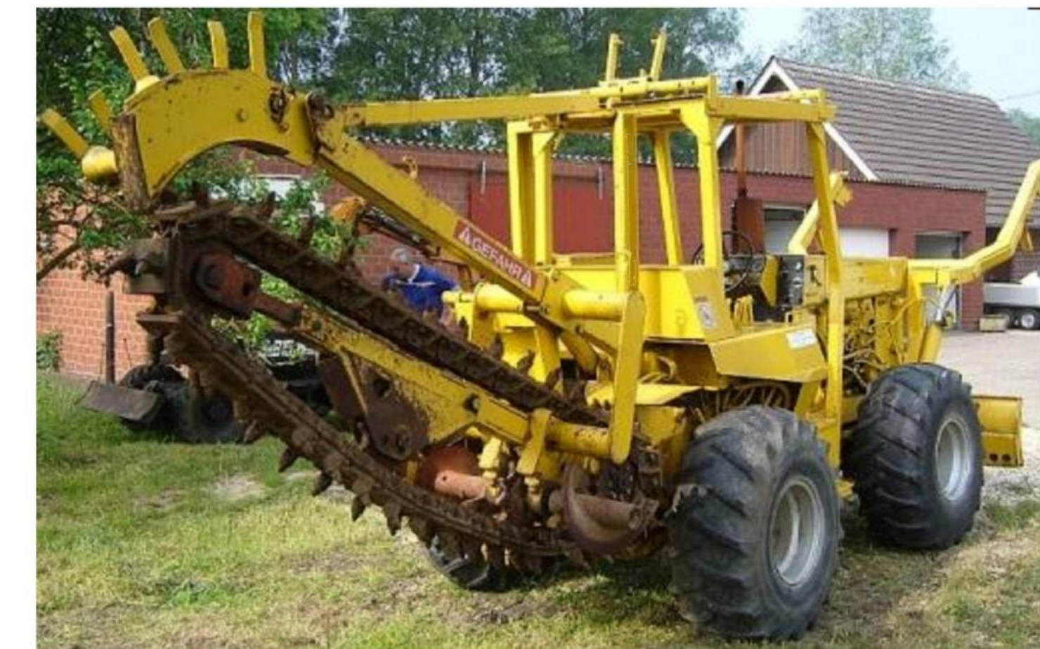
Рисунок 6 – Ditch Witch 6510 H_k=120\text{мм} , b=25\text{мм}
