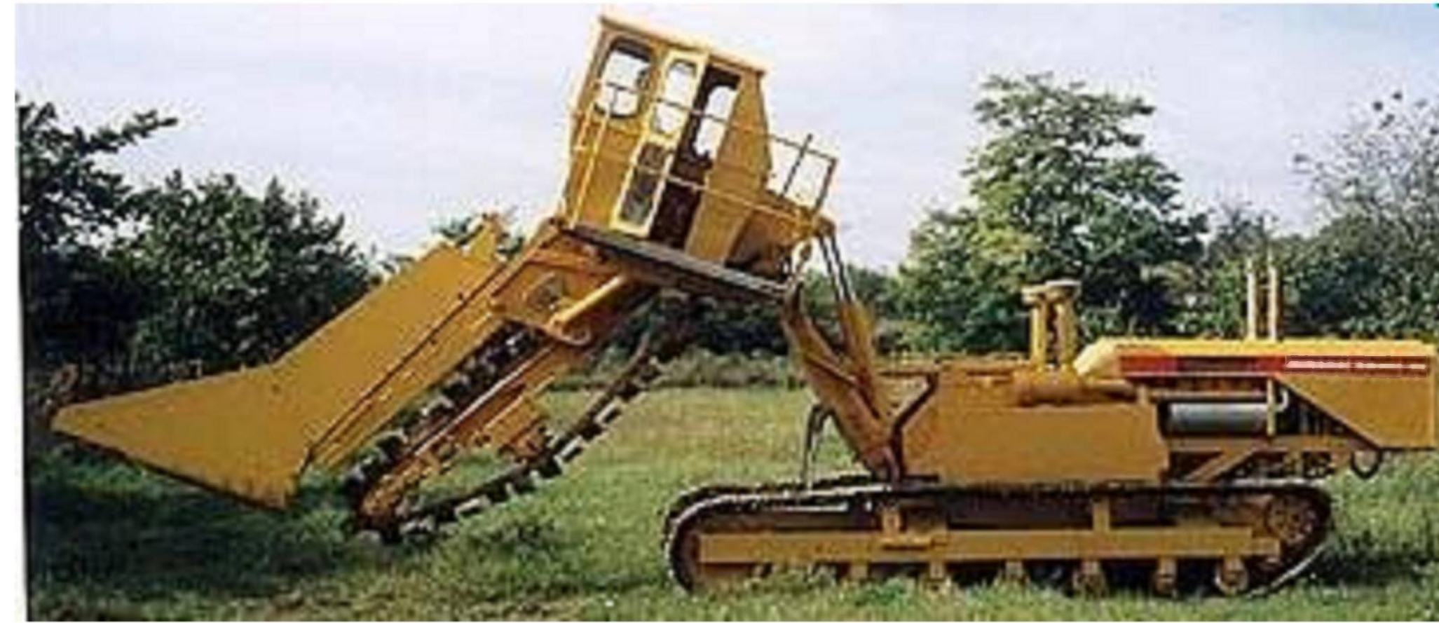
Рисунок 5 – Dynapac Hoes 685 Gigant H_k=180\text{мм} , b=40\text{мм}
