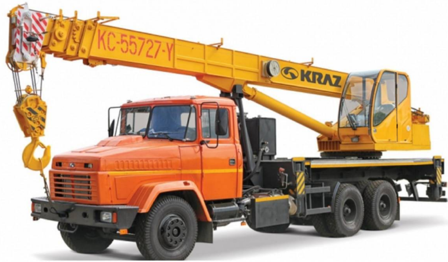
Рисунок 1 – Кран КС-55727-У на базі шасі КраЗ-65053 з вантажопід'ємністю 25т
