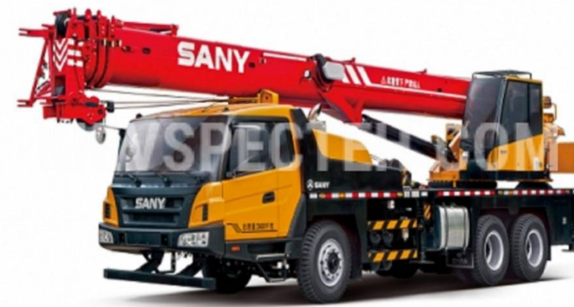
Рисунок 5 – Автокран Palfinger Sany STC 160 з колісною формулою 6x4x2, вантажопід'ємністю 16т
