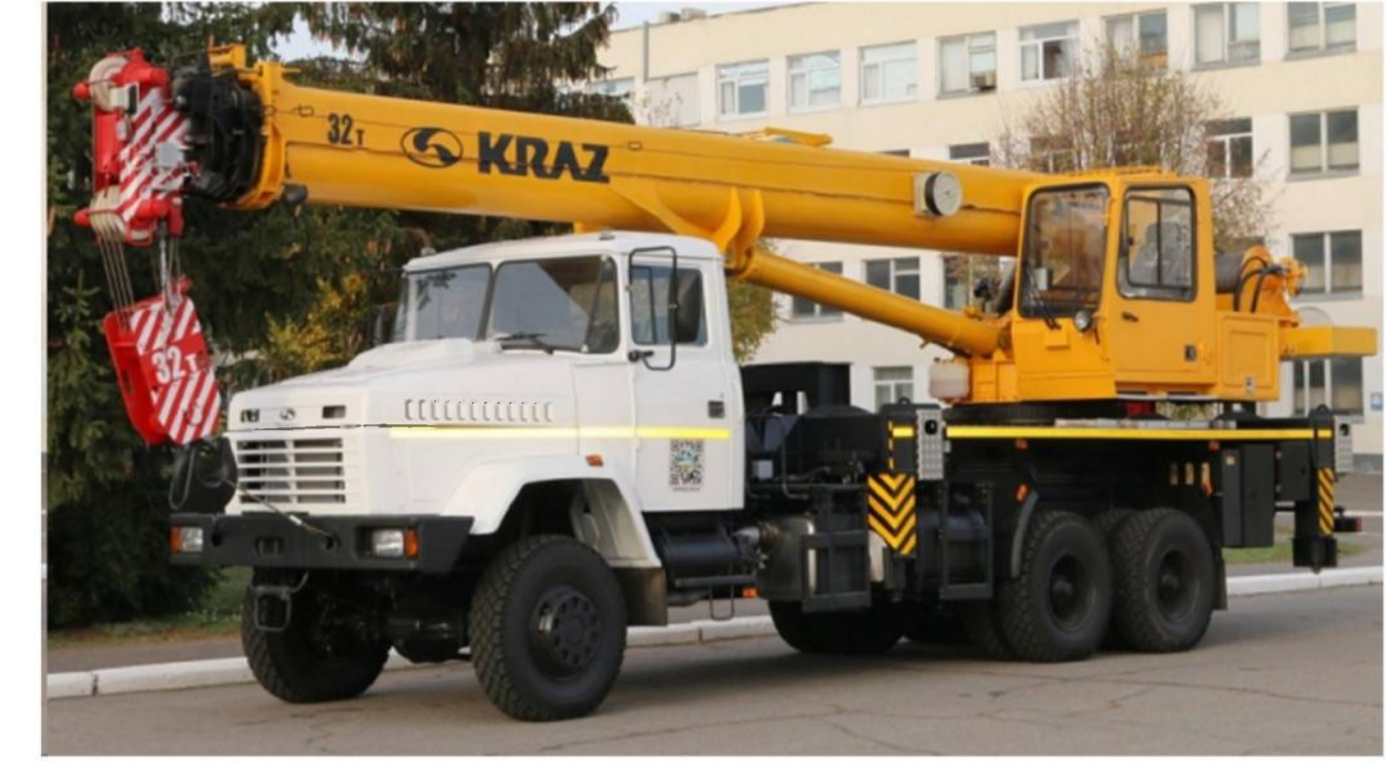
Рисунок 3 – Кран на базі шасі КраЗ-6322 з вантажопід'ємністю 32т
