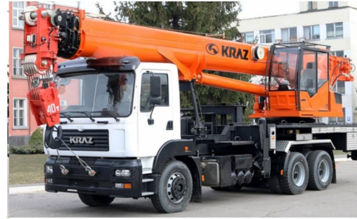
Рисунок 2 – Кран на базі шасі КраЗ-651Н4 з вантажопід'ємністю 40т
