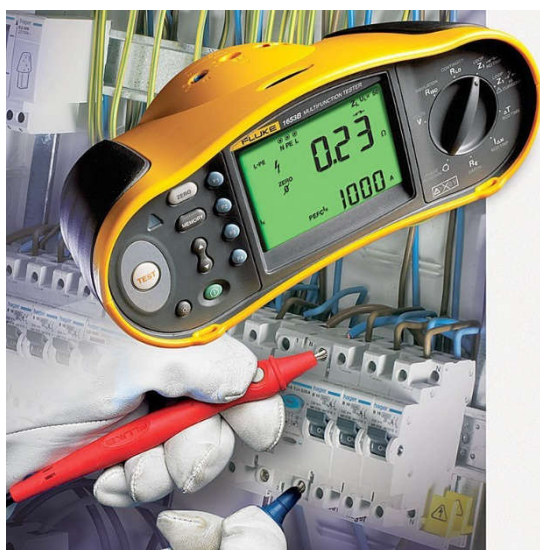
Рисунок 1.18 – Вимір опору ізоляції
