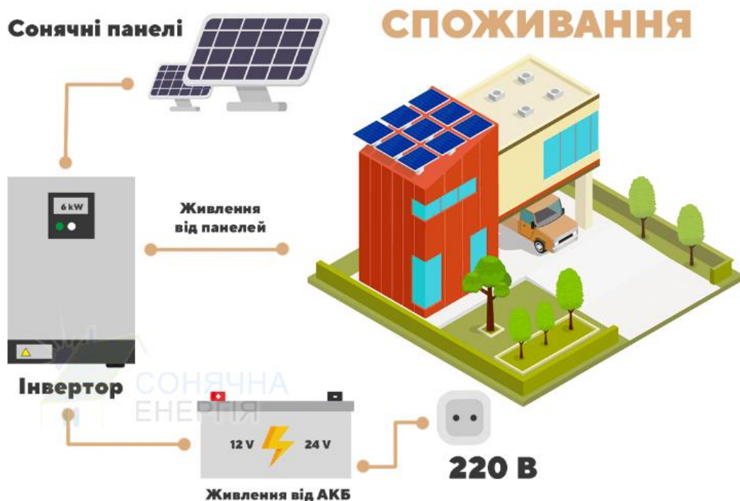
Рисунок 3.1 – Схематичне зображення підключення автономного інвертора
