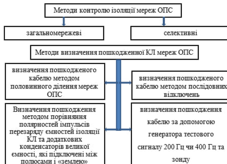
Рисунок 1.10 – Методи контролю ізоляції ОПС
