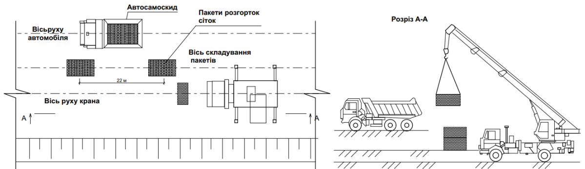
Рисунок 4.3 - Схема розвантаження пакетів габіонів
